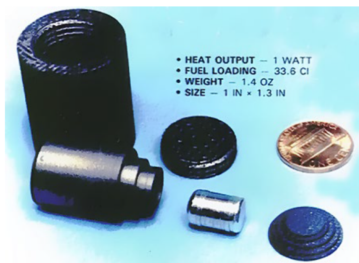
Figura 4 – Módulo RHU de ^{238}\text{Pu} pesa somente 40g, com 3,2 cm de comprimento e 2,6 cm de diâmetro e produz 1 W térmico. Fonte: Ragheb (2021) .
