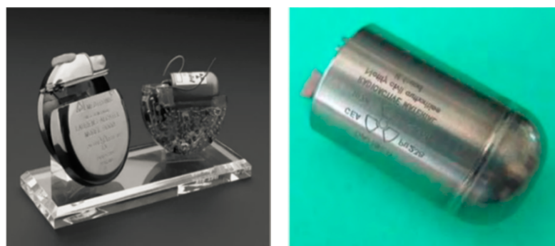
Figura 1 – Marca-passos (esq.) e uma bateria nuclear GTR (dir.). Fonte: Zoui et al. (2020).
