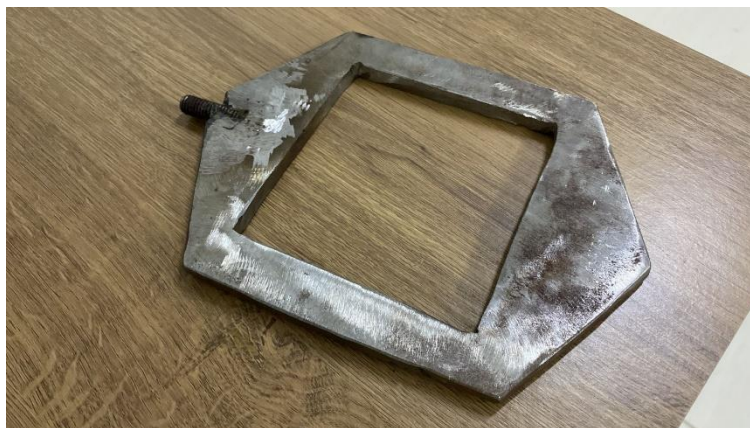
Figura 20 - Placa metálica adaptada elaborada para ensaio
