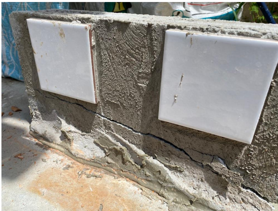
Figura 45 - Detalhe do bloco quebrados durante o ensaio
