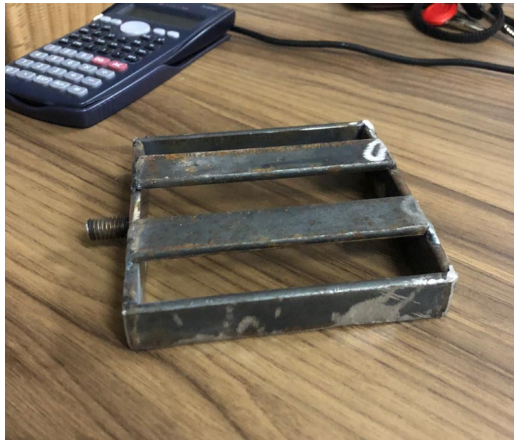
Figura 35 - Camisa metálica reforçada com duas chapas
