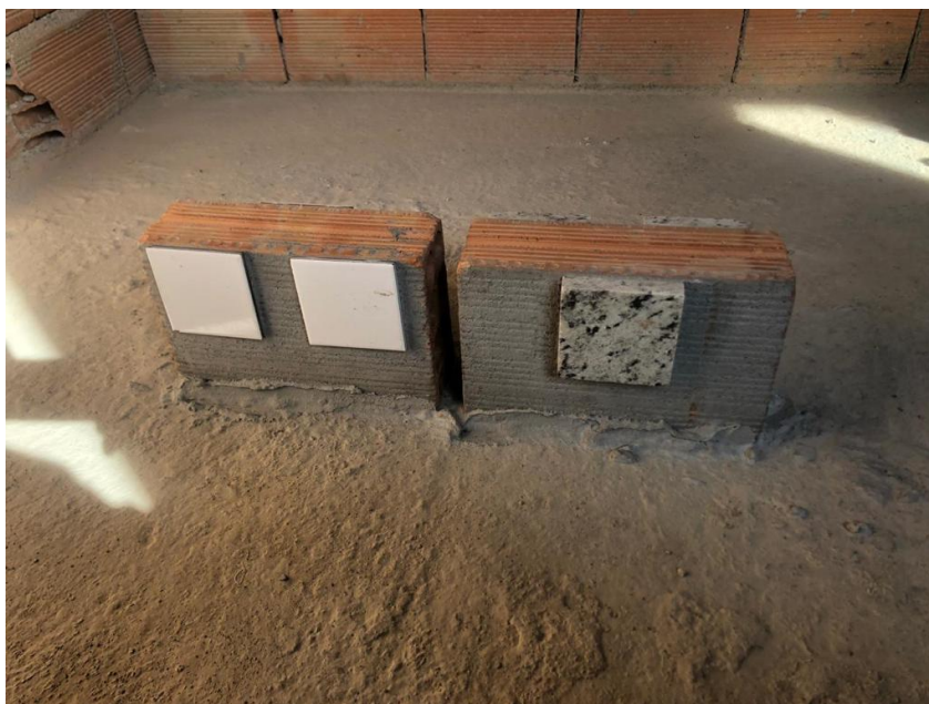
Figura 32 - Corpos de prova assentados no piso com ACIII
