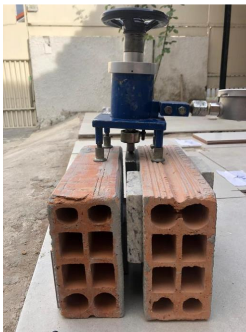
Figura 22- Disposição do aderímetro para realização do ensaio
