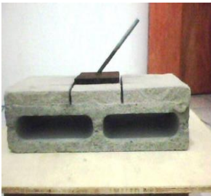
Figura 13 – Corpo de prova para ensaio de arrancamento a 45°
