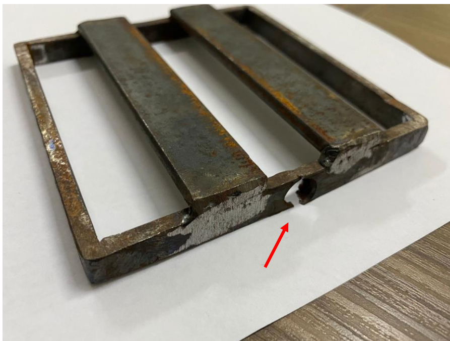
Figura 37 - Camisa metálica com a ruptura barra roscada
