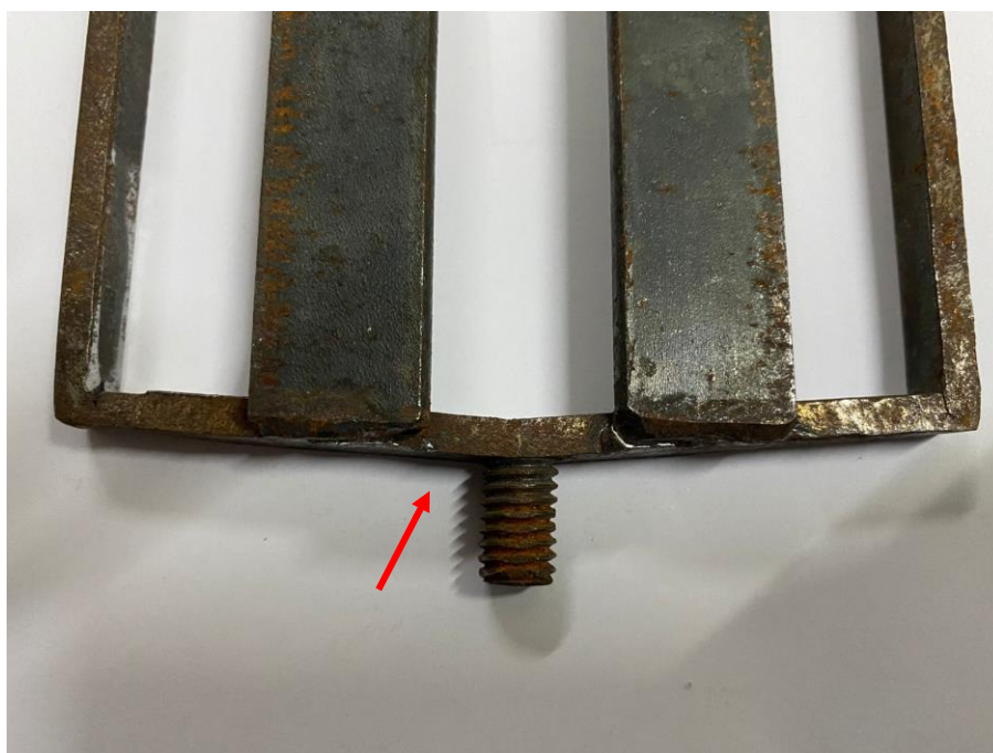
Figura 36 - Deformação da camisa metálica com reforço de chapas
