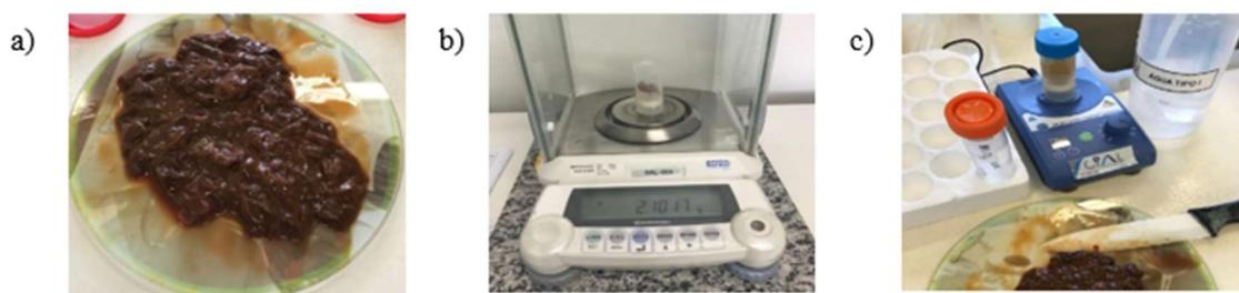
Figura 10: Etapas iniciais do preparo da amostra: a) amostra picada com faca de cerâmica; b) pesagem da amostra; c) trituração da amostra em meio ácido no Ultraturrax.
