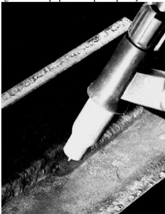
Figura 18 - Equipamento para aplicação d TIG.
