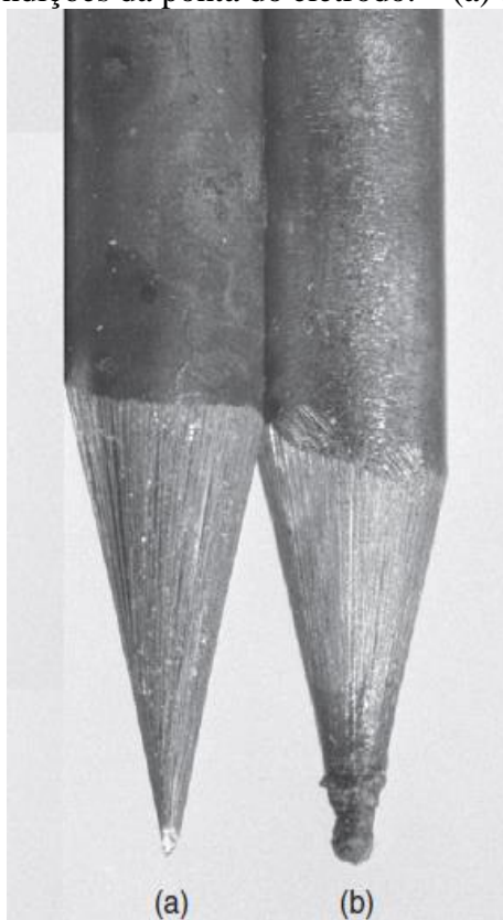
Figura 19 - Condições da ponta do eletrodo. – (a) boas e (b) ruins.
