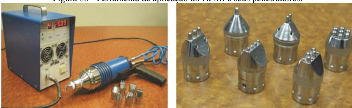
Figura 35 - Ferramenta de aplicação do HFMI e seus penetradores.
