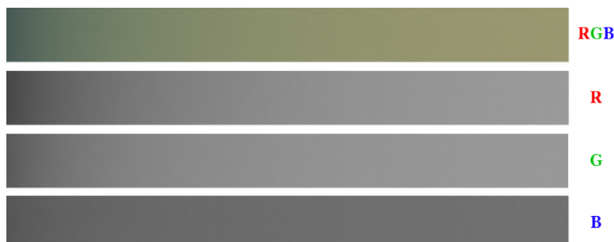
Figura 31 – Filme utilizado a obtenção das informações de intensidade de cor para perfil de dose em profundidade. A primeira fit a de filme de cima para baixo mostra o filme com as três componentes de cor juntas, as restantes mostram os canais R, G e B separados e apresentados em escala de cinza. Elaborado pelo Autor.
