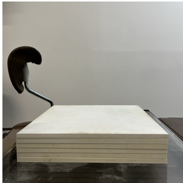
Figura 10 – Placas de água sólida Gammex® 457, nesta imagem pode-se ver 6 placas de 10 mm de espessura empilhadas, a fotografia foi obtida durante o preparo de um arranjo experimental. Acervo do Autor.
