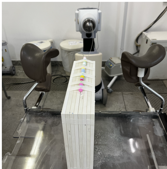
Figura 17 – Arranjo experimental para perfil de dose em profundidade. Acervo do Autor.
