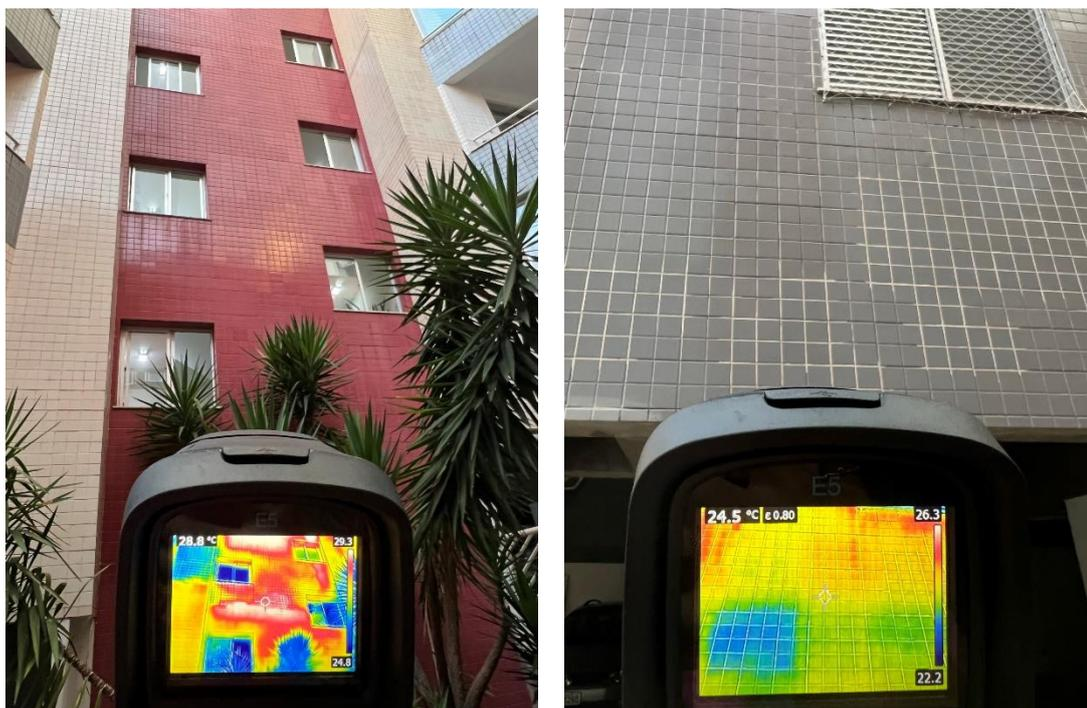
Portanto, principalmente quando há pouca distância entre o alvo e o instrumentador a investigação é dificultada, uma vez que o equipamento não oferece visualização global do pano da fachada, sendo necessária a tomada de diversas fotografias para análise da mesma região visualizada digitalmente.
