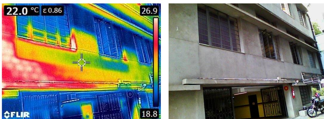
Dessa forma, identificou-se um potencial auxílio da termografia em eventuais situações que seja necessário o conhecimento da localização das estruturas (pilares, vigas) ou do tipo do sistema de vedação utilizado na construção.
