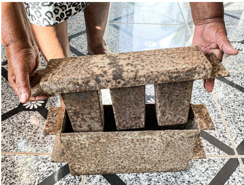
Figura 132 – Forma de bloco usada para construção da casa da Dona Armeni
