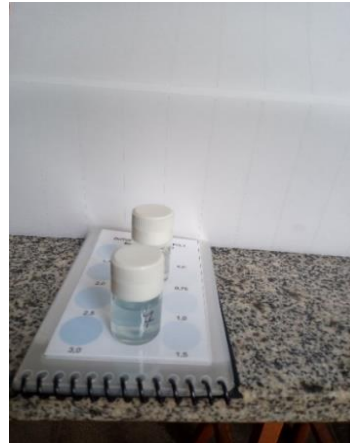
Figura 18 - Análise de fosfato com utilização do kit Alfakit
