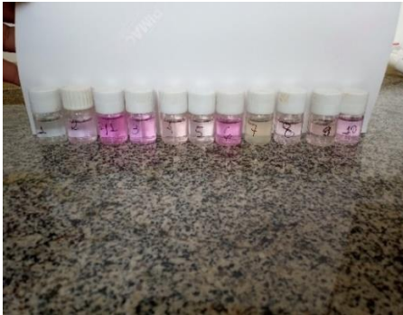
Figura 19 - Análise de nitrato com utilização do kit Alfakit
