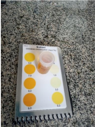
Figura 17 - Análise de oxigênio dissolvido com utilização do kit Alfakit
