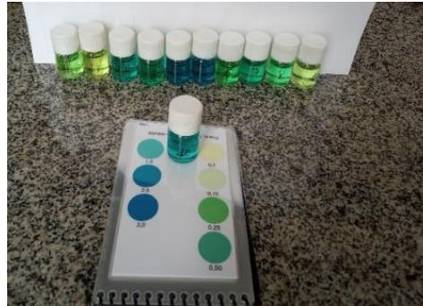
Figura 20 - Análise de amônia com utilização do kit Alfakit
