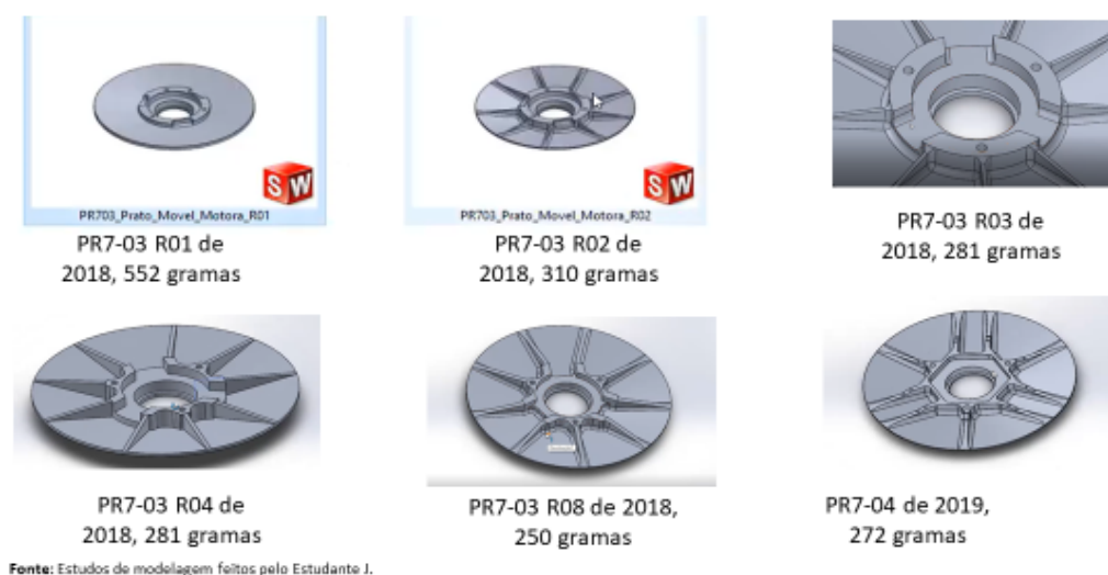
FIGURA 31 - EVOLUÇÃO DA POLIA MOTORA CVT PR703 À PR704
