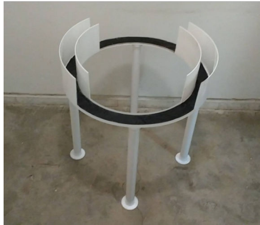
Figura 5 Modelo de Labirinto em Zero Elevado. Aparelho utilizado no teste de Labirinto em Zero Elevado formado por um anel circular suspenso do solo e composto por braços abertos e fechados intercalados.
