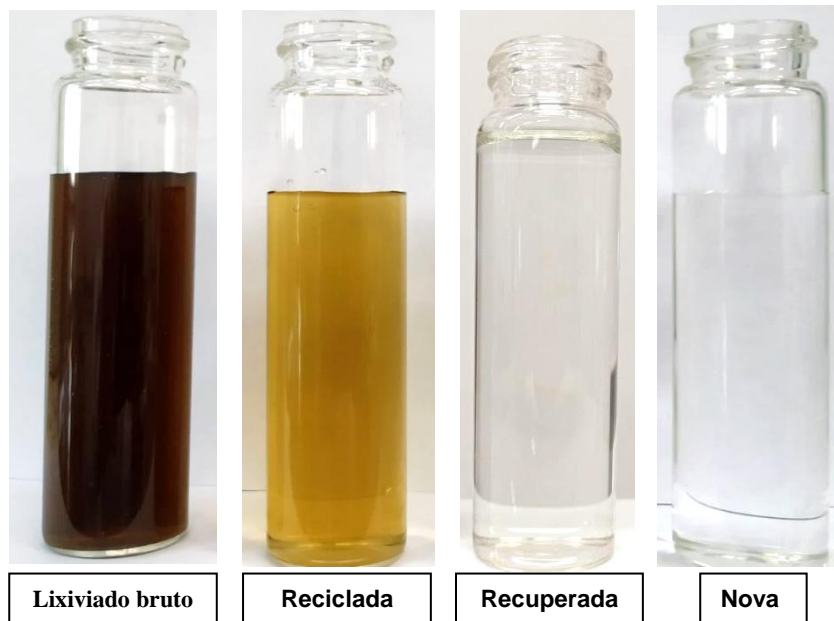
Figura 22 - Lixiviado bruto e permeado das membranas reciclada, recuperada e nova de OI AG4040FM
