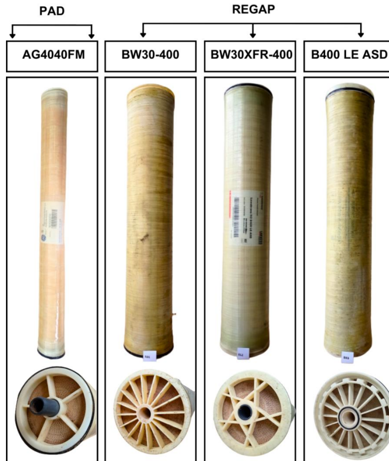
Figura 9 - Registros fotográficos dos módulos e dos espaçadores
