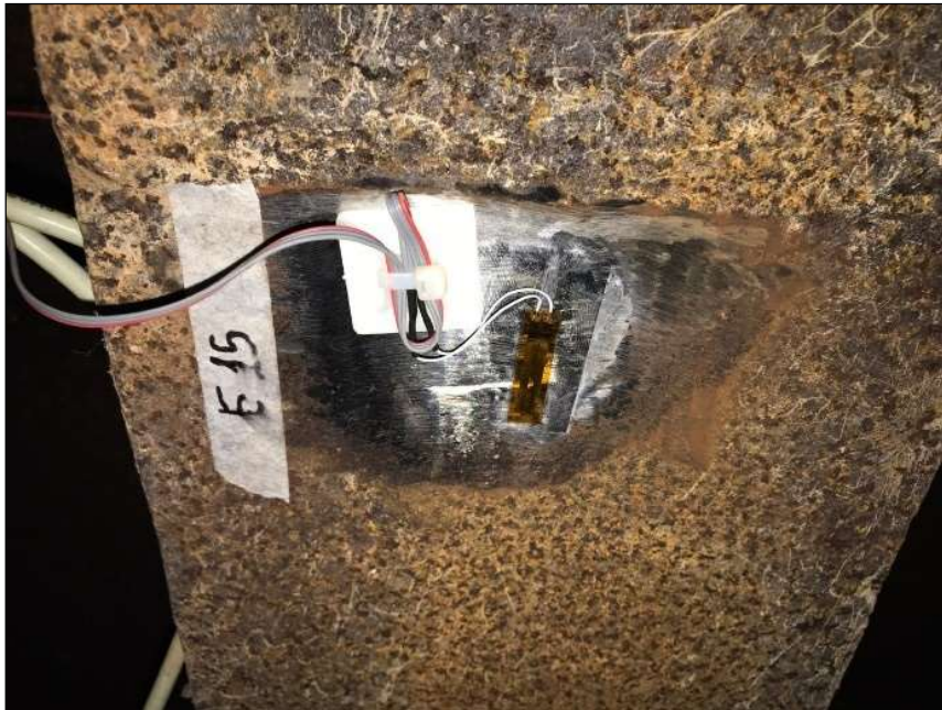
Figura 19 - Extensômetro E15, transversina intermediária.
