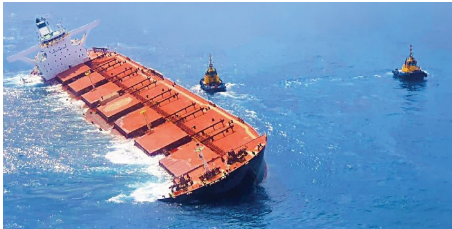
Figura 1: Navio adernado por liquefação de carga granel
