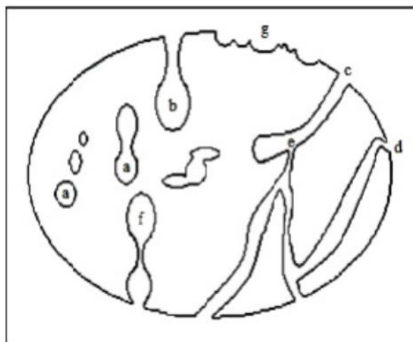
Figura 2 - Classificação dos poros em materiais sólidos porosos: fechado (a), poros “cegos” (b) e (f), poro interconectado (e), gargalo (b), cilíndricos (c), afunilados (d) e irregular (f) Fonte: (GOMES, 2011) [36].
