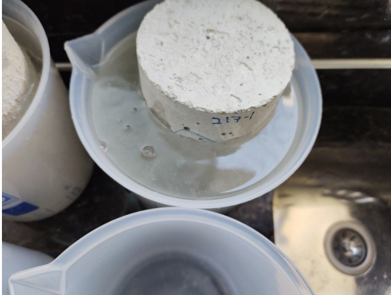
FIGURA 23 - Corpo de prova 10x20cm imersos em solução de ácido sulfúrico ( H_2SO_4 ) a 2,5%.
