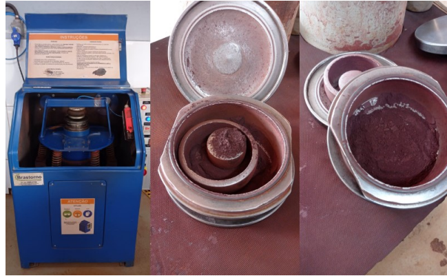
Figura 16 – Representação da Amostra Sendo Pulverizada em Moinho de Panelas (Arquivo Interno, 2022).
