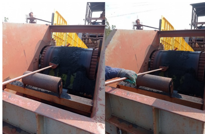
Figura 12 – Representação da Coleta dos Incrementos das Amostras de Produto da Concentração por espirais (Arquivo Interno, 2022).
