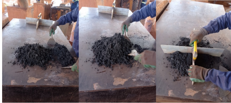
Figura 13 – Representação da Primeira Fase de Homogeneização e Quarteamento das Amostras de Produto da Concentração por espirais (Arquivo Interno, 2022).
