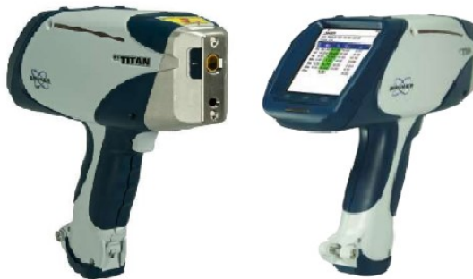
Figura 08 – FRX Portátil modelo S1 TITAN 600 [3]
