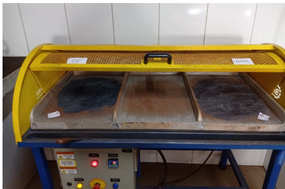
Figura 14 – Representação da Disposição da Amostra em Chapa Térmica para Secagem (Arquivo Interno, 2022).
