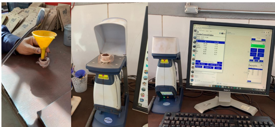
Figura 17 – Representação da Amostra Sendo Analisada no FRX-P (Arquivo Interno, 2022).
