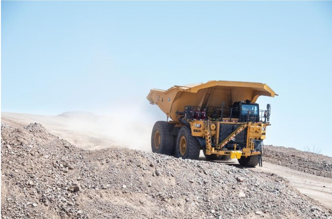
Figura 3.6 – Caminhão fora de estrada CAT 793 realiza transporte de material em uma mina a céu aberto (Fonte: WWW.CAT.COM, 2023).
