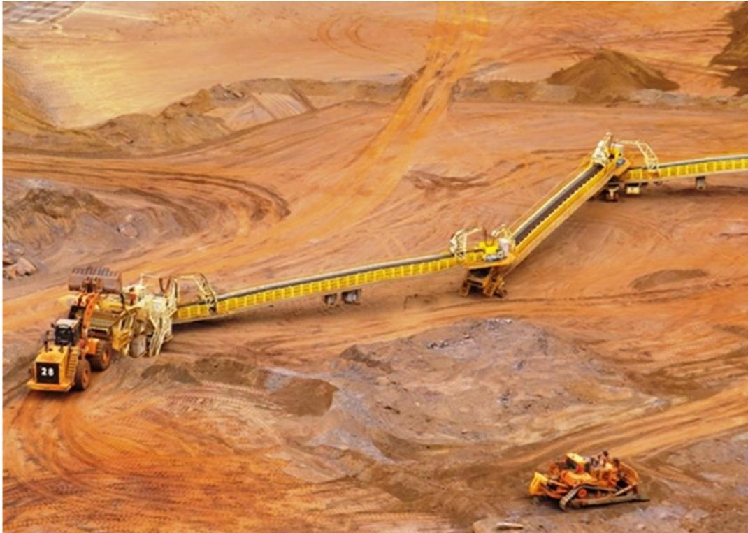
Figura 3.10 – Sistema de lavra por correias de bancada em mina a céu aberto na Samarco Mineração (Fonte: CONTRIBUIÇÃO DO AUTOR).
