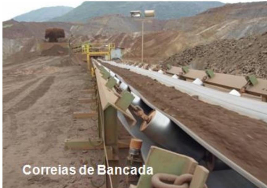
Figura 3.8 – Sistema de correias de bancada instaladas na mina da Samarco (Fonte: LOPES, 2010).
