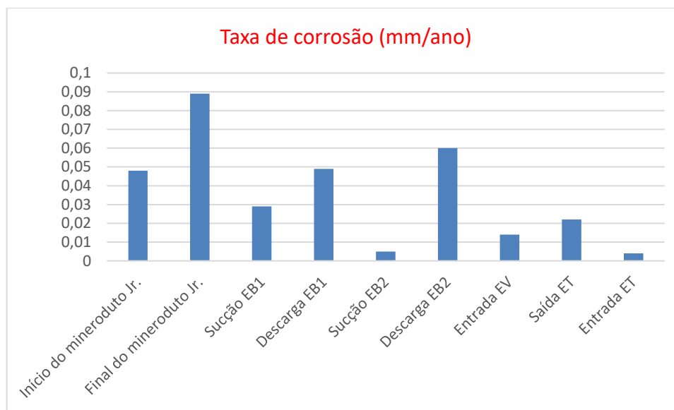
Figura 4.34 - Valores de taxa de corrosão.
