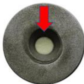
Figura 3.13- Área existente sob o suporte de fixação do cupom de perda de massa.
