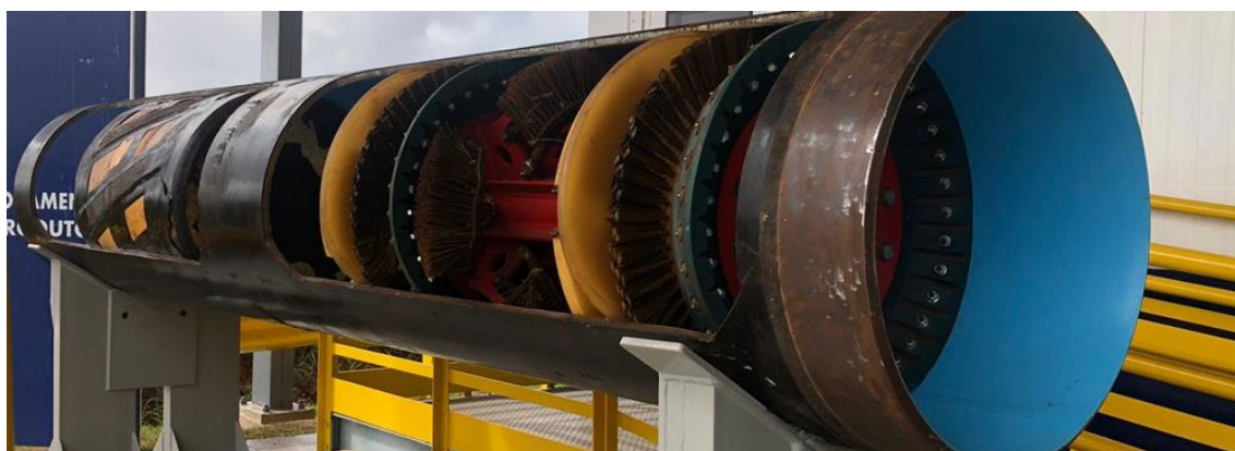
Figura 3.14 - PIG de limpeza.
