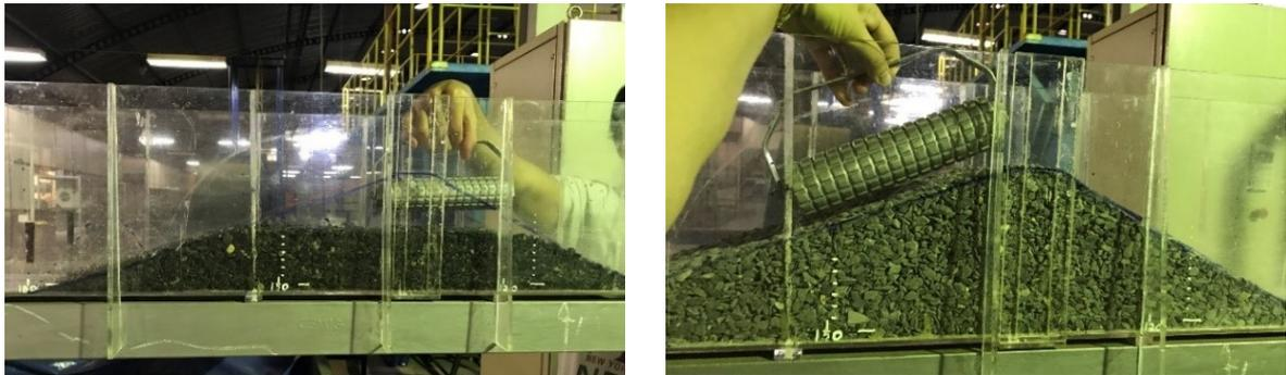
Para avaliar os efeitos da compactação na estabilidade hidráulica da estrutura, a construção do maciço do dique foi realizada por meio da formação de camadas de 2,5 cm e passagem de rolo de aço (Figura 37) com um intervalo de tempo fixo, buscando-se adotar uma velocidade constante.
