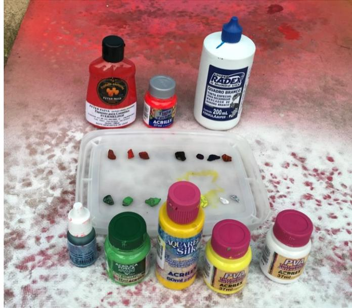
**Figura 32 – Tinta para artesanato, acrílica fosca, selecionada para a pintura das britas**
