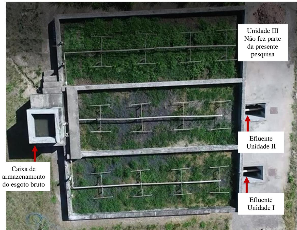
**Figura 3.3** - Registro aéreo da estação de tratamento de efluentes experimental localizada na ETE Arrudas.
