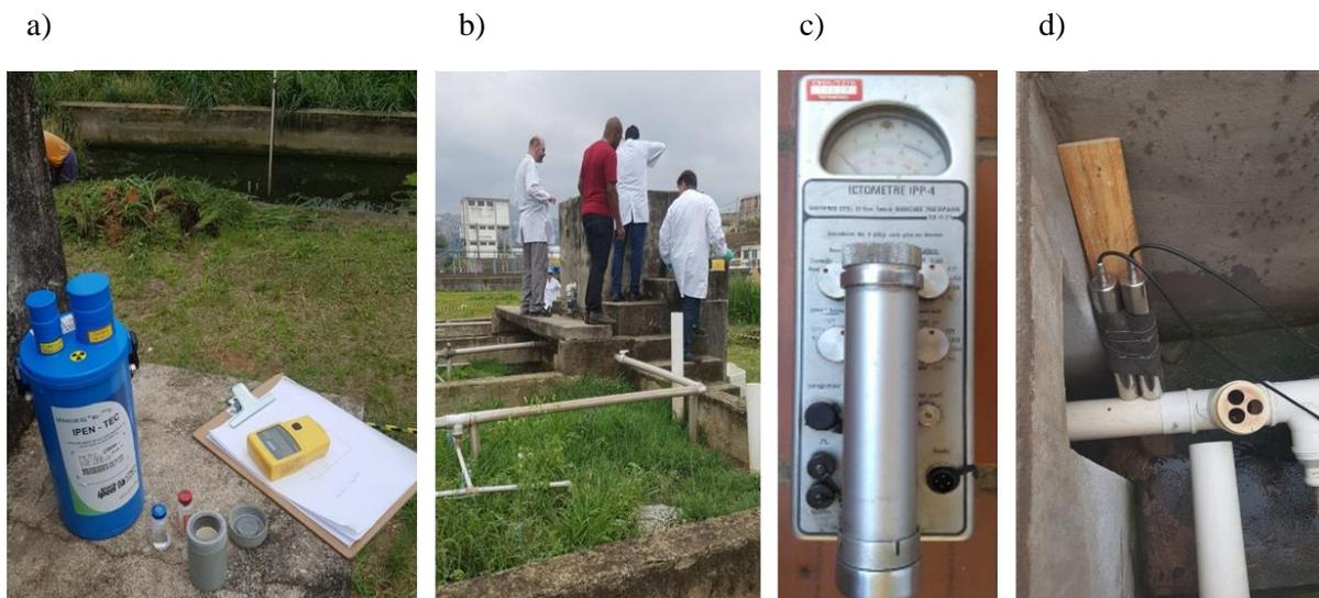
**Figura 0.5** - a) Gerador de  $^{99}\text{Mo}$ - $^{99\text{m}}\text{Tc}$ ; b) Aplicação do  $^{99\text{m}}\text{Tc}$  na caixa de armazenamento de esgoto bruto - equipe CDNT; c) Contador de Geiger-Müller; d) Cintilador dentro da caixa de passagem, recostado na tubulação de coleta de efluente tratado.
