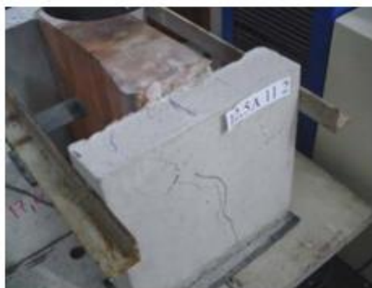
Figura 2.32 - Falha no concreto
