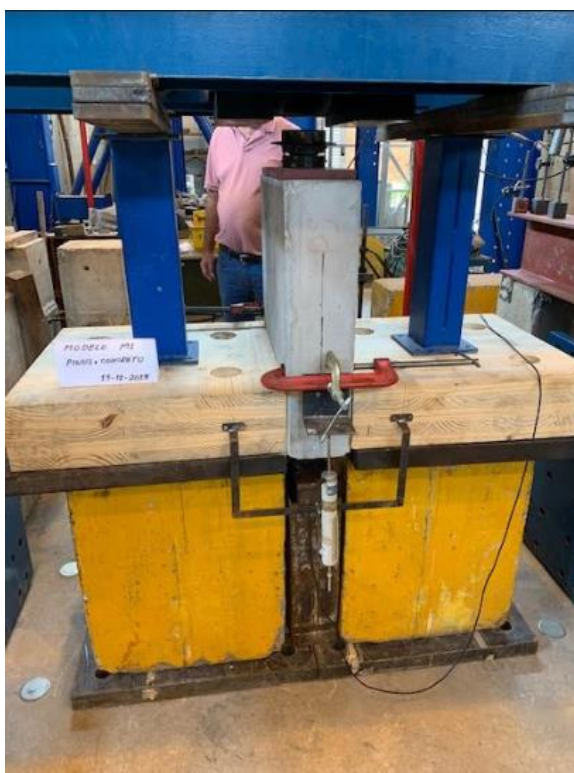
Figura 6.20 - Ensaio de cisalhamento direto
