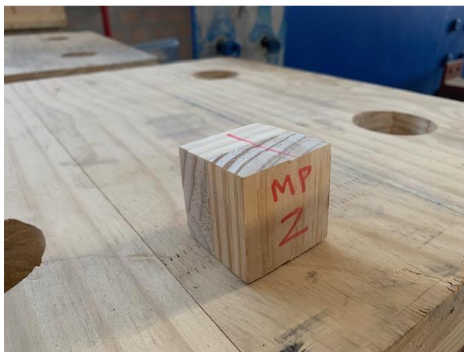
Figura 5.16 - Corpo de prova para resistência ao cisalhamento paralelo às fibras
