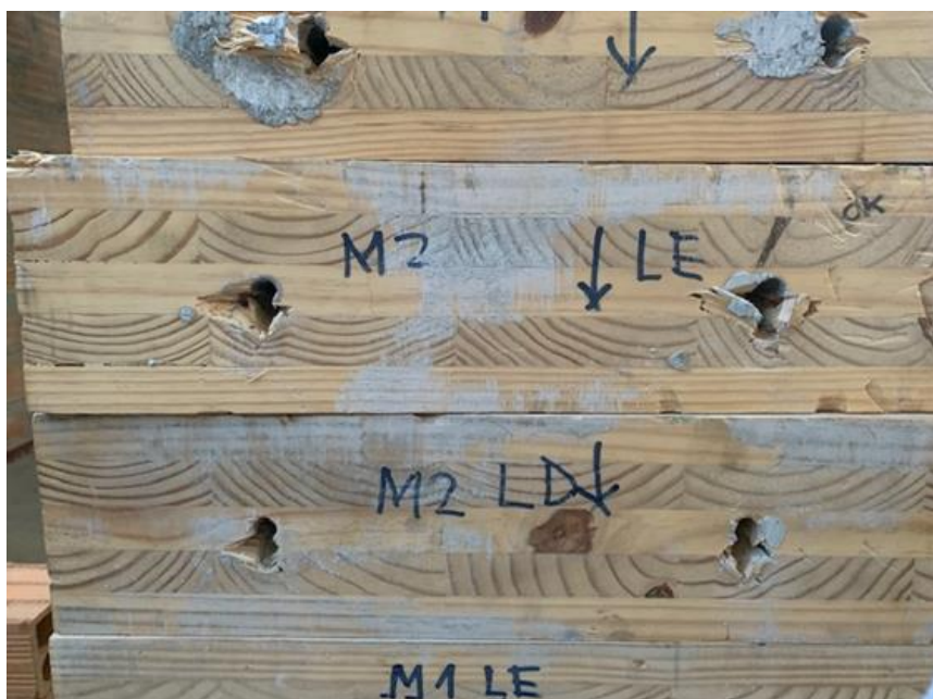
Figura 6.34 – Embutimento e arrancamento no modelo M2 de madeira, lado direito e esquerdo
