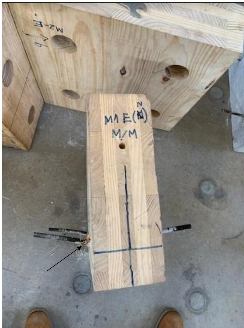
Figura 6.52 - Detalhe das rótulas plásticas do conector e esmagamento no painel central
