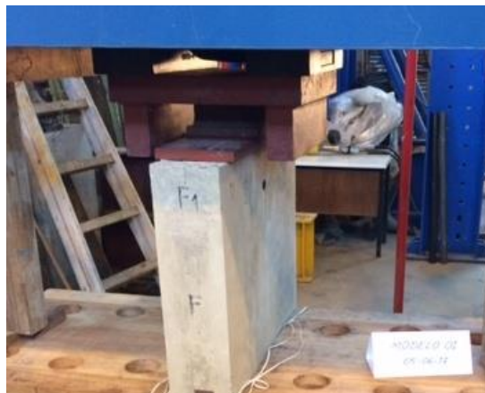
Figura 4.43 - Posicionamento das chapas de aço Figura 4.44 – Aparelho de interface central.
