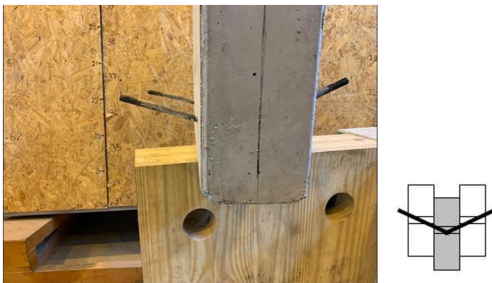
Figura 6.35 – Rótulas plásticas nos conectores, modelo M3
