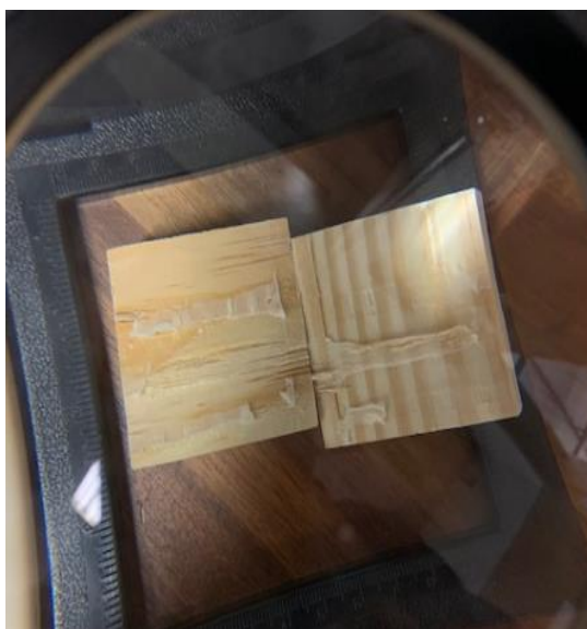
Figura 5.36 - Cisalhamento na linha de cola
