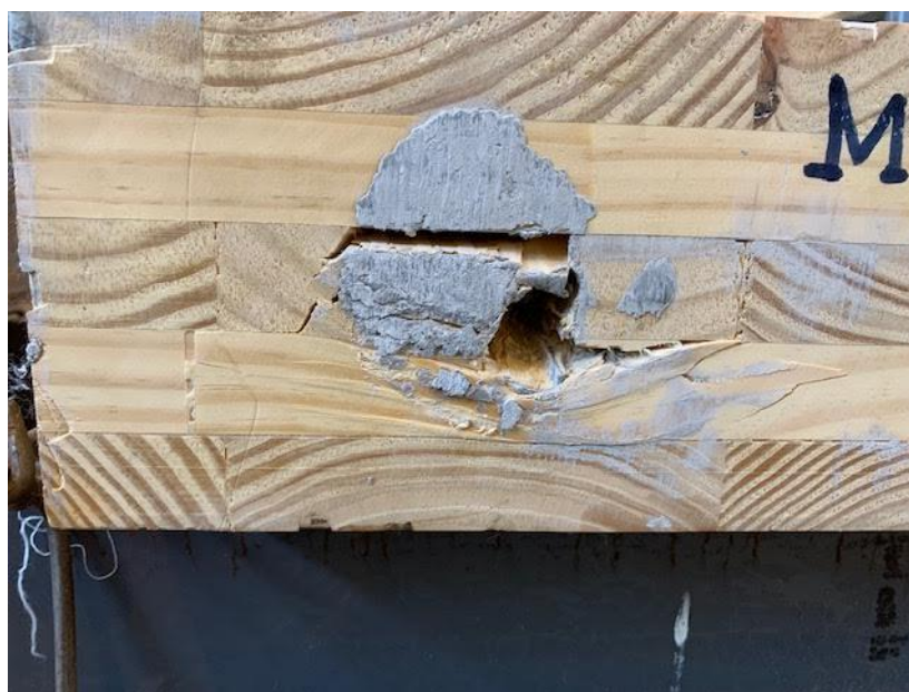
Figura 6.25 - Detalhe do esmagamento lado direito da peça de madeira paralelo às fibras
