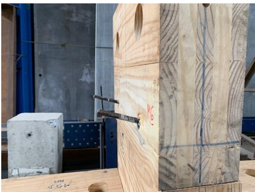
Figura 6.68 – Esmagamento da madeira e rótulas plásticas no modelo M6 de madeira/madeira
