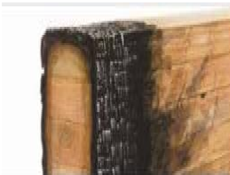
Figura 1.2 - Madeira exposta ao fogo por 30 minutos
