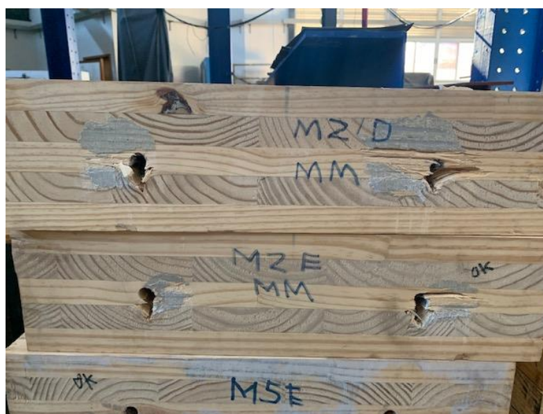
Figura 6.60 – Embutimento e arrancamento no modelo M2 de madeira, lado direito e esquerdo
