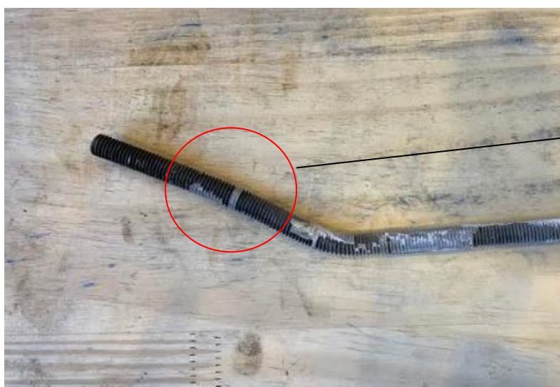
Figura 6.21 - Detalhe das rótulas plásticas do conector (modo de ruptura IV)
