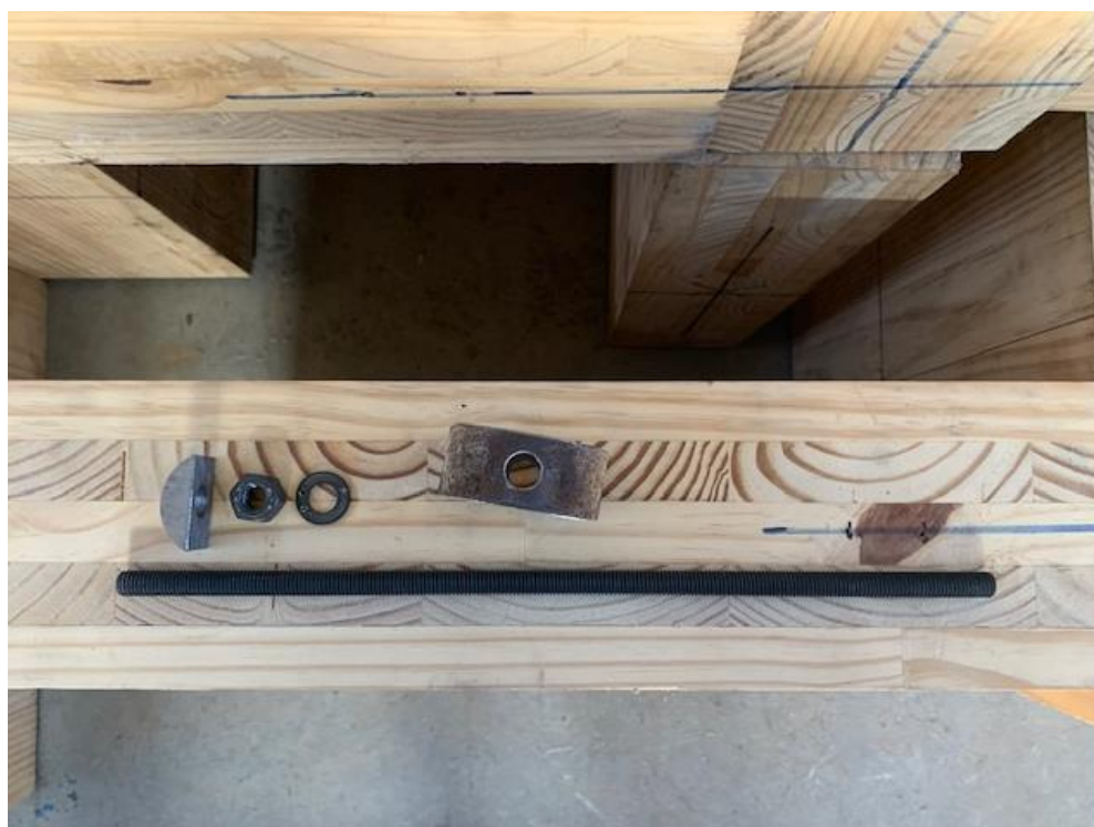
Figura 5.21- Corpo de Prova para momento de plastificação do conector
