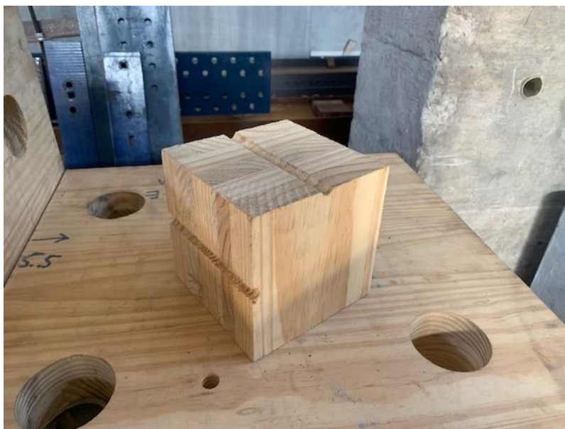
Figura 5.12– Corpo de prova para embutimento na madeira
