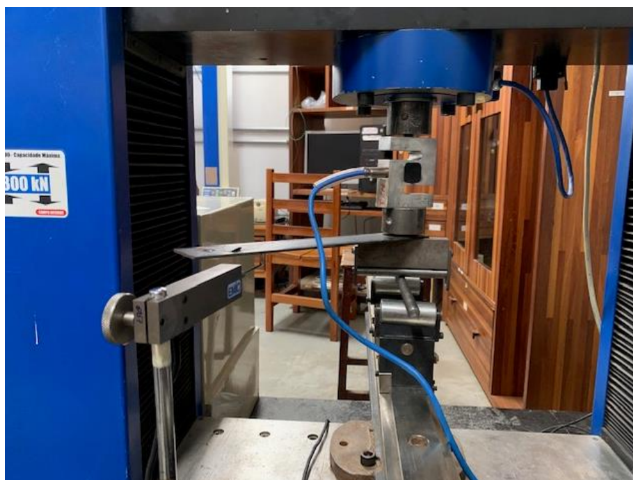
Figura 5.41- Ensaio para determinação do momento de plastificação do conector
