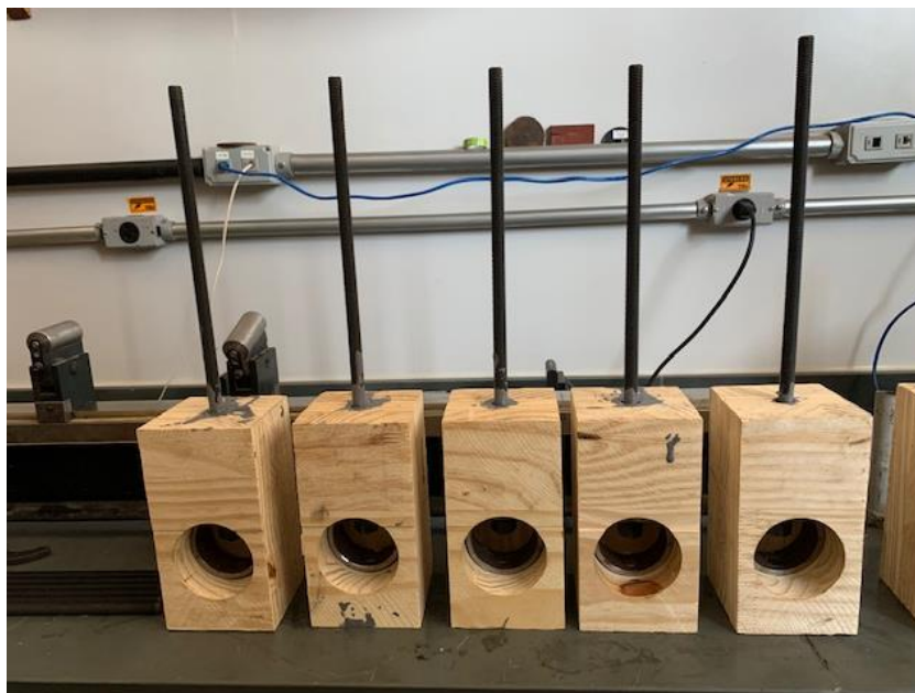
Figura 5.17 – Corpo de prova para ensaio de arrancamento
