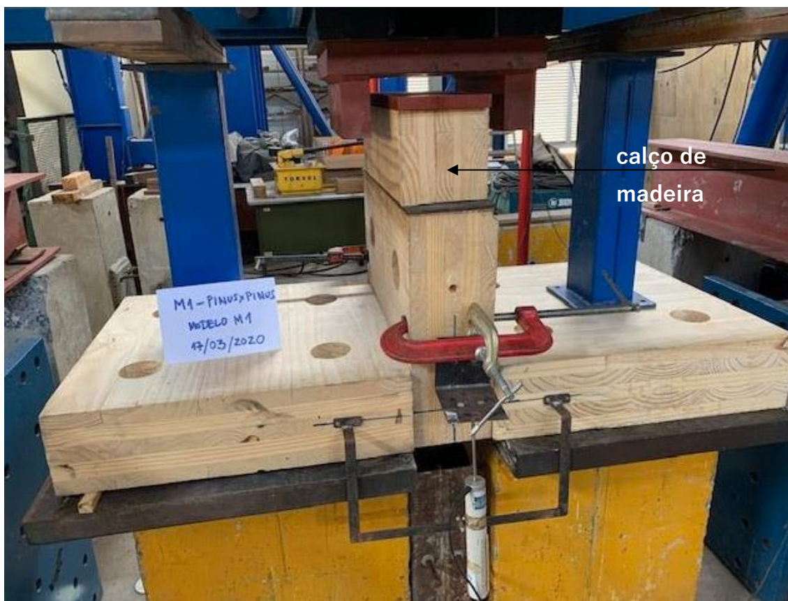
Figura 6.49 - Ensaio de cisalhamento direto modelo madeira/madeira/madeira
