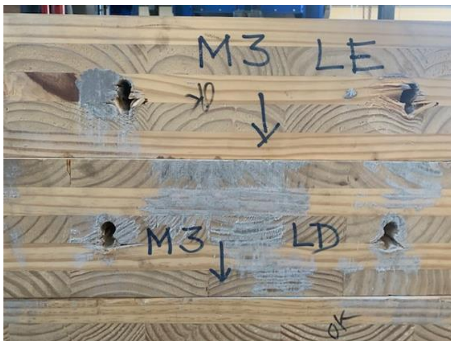
Figura 6.37 – Embutimento e arrancamento no modelo M3 de madeira, lado direito e esquerdo
