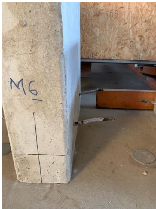
Figura 6.44 - Rótulas plásticas nos conectores, modelo M6
