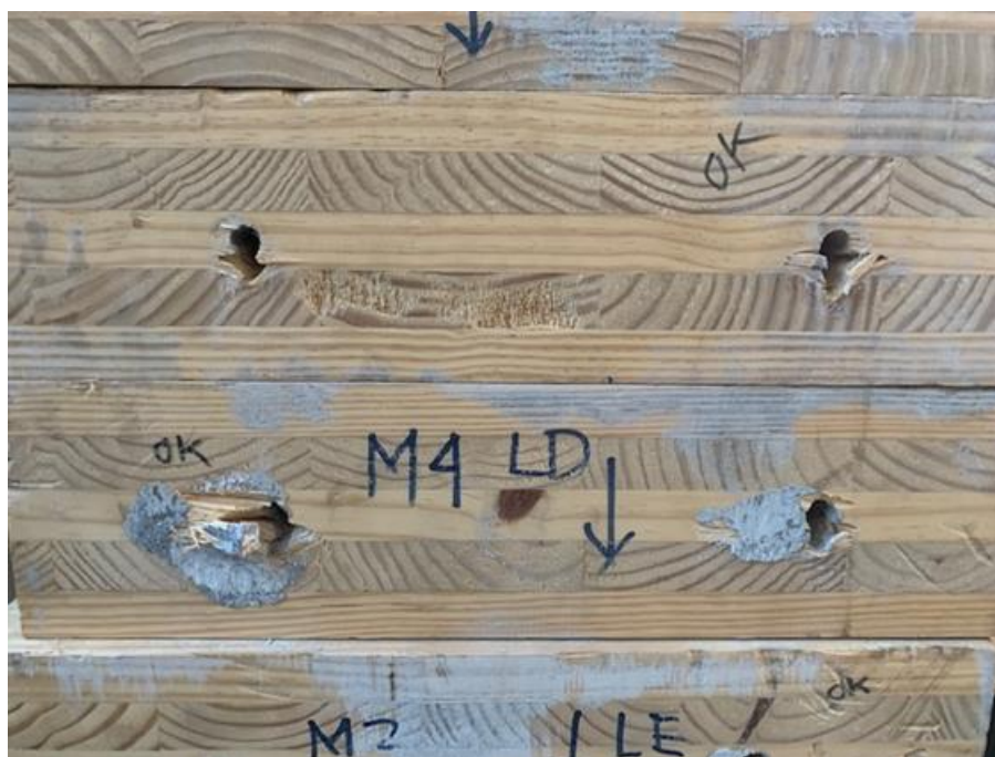
Figura 6.40 – Embutimento e arrancamento no modelo M4 de madeira, lado direito e esquerdo
