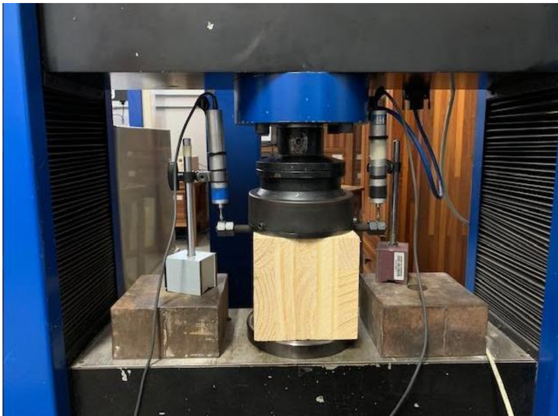
Figura 5.28 – Ensaio de embutimento na madeira sendo realizado
