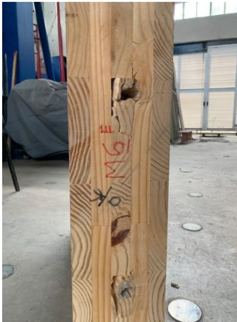
Figura 6.69 – Embutimento e arrancamento no modelo M6 de madeira/madeira
