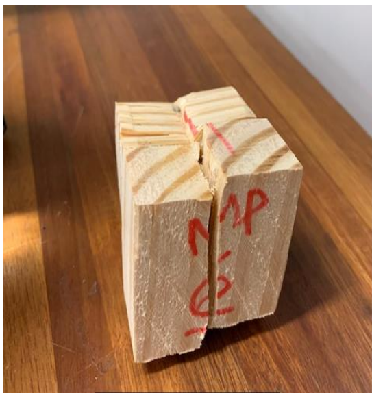
Figura 5.33 - Ensaio de cisalhamento paralelo Figura 5.34 - Ensaio de cisalhamento paralelo
