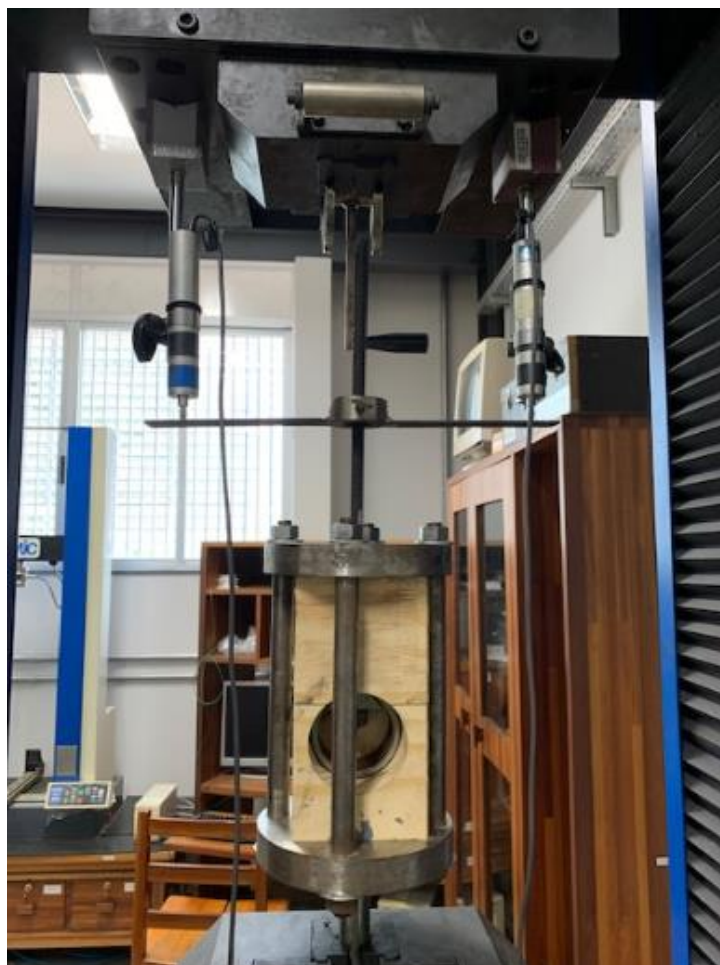
Figura 5.38 - Acessório para o ensaio de arrancamento e transdutores de deslocamento
