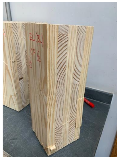
Figura 5.14 – CPs para compressão
