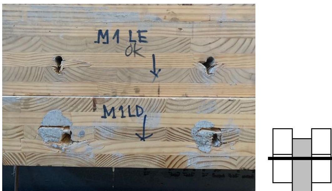
Figura 6.24 – Embutimento e arrancamento no painel de madeira, lado direito e esquerdo
