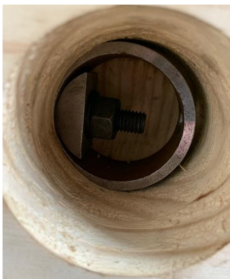
Figura 6.22 - Penetração do anel de aço
