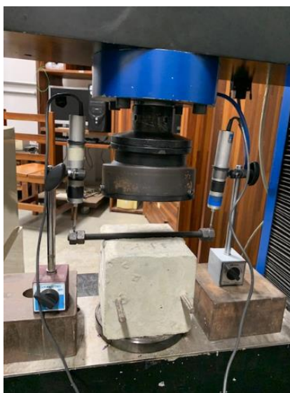
Figura 5.24 - Ensaio de embutimento no concreto
