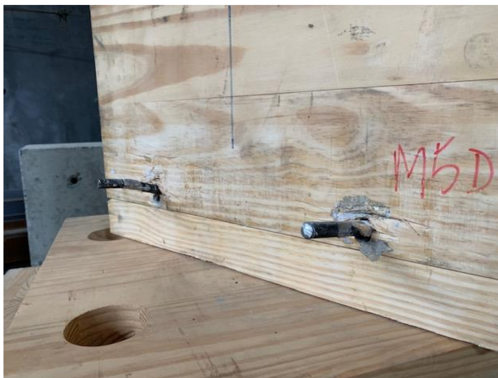
Figura 6.67 – Esmagamento da madeira e rótulas plásticas no modelo M5 de madeira/madeira
