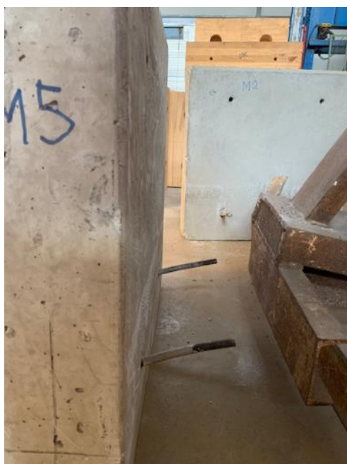
Figura 6.41– Rótulas plásticas nos conectores, modelo M5
