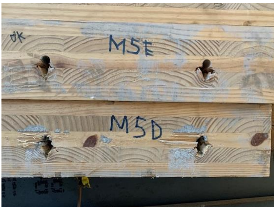
Figura 6.43 – Embutimento e arrancamento no modelo M5 de madeira, lado direito e esquerdo
