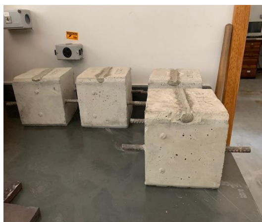
Figura 5.19- CP para embutimento no concreto Figura 5.20- CP embutimento com graute
