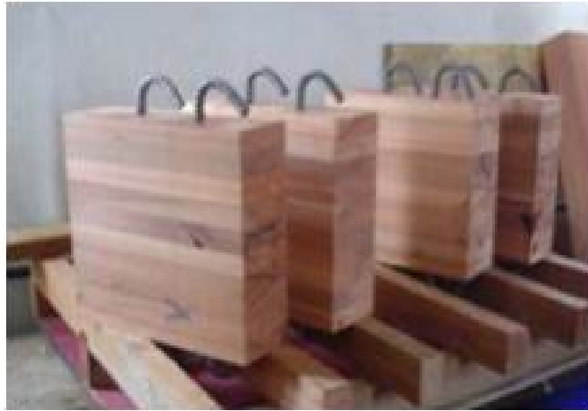
Figura 2.28 - Painéis de madeira com o conector colado
