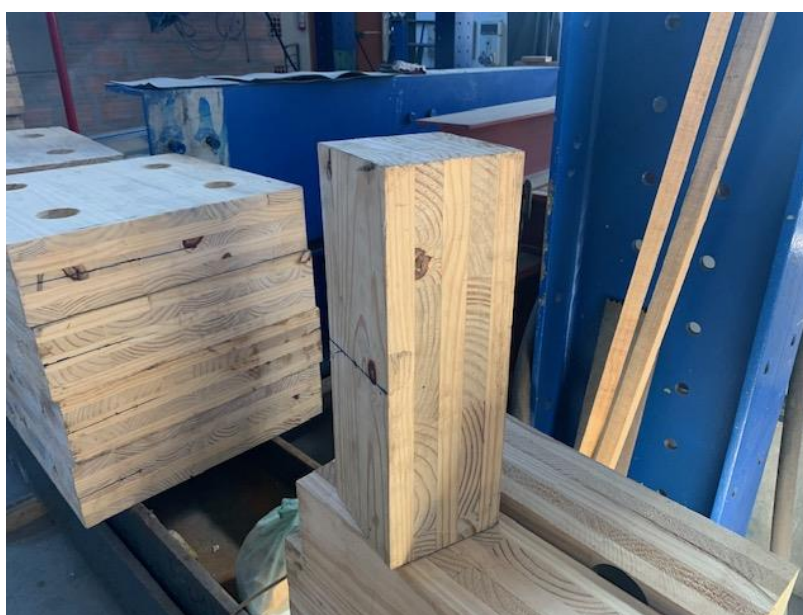
Figura 5.30 – Corpo de prova para ensaios de compressão na madeira
