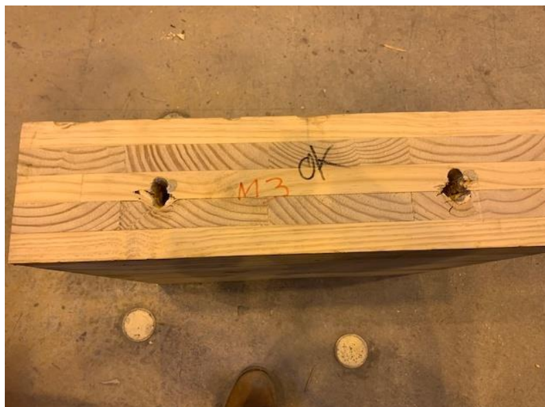
Figura 6.62 – Embutimento e arrancamento no modelo M3 de madeira/madeira
