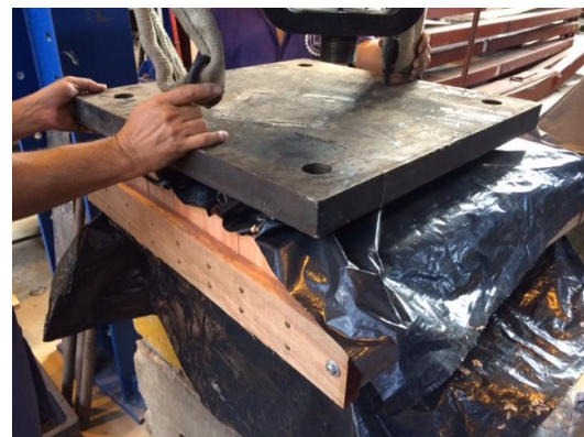
Figura 4.10- Colocação da chapa superior
