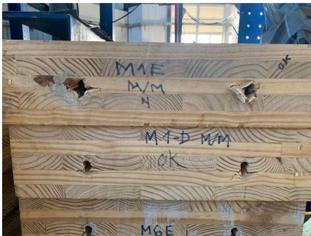
Figura 6.51 - Embutimento e arrancamento no modelo M1 de madeira, lado direito e esquerdo
