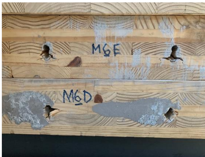
Figura 6.46 – Embutimento e arrancamento no modelo M6 de madeira, lado direito e esquerdo
