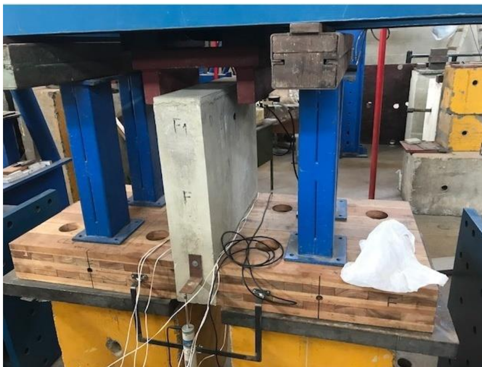
Figura. 4.36 – Pórtico de reação MTS
