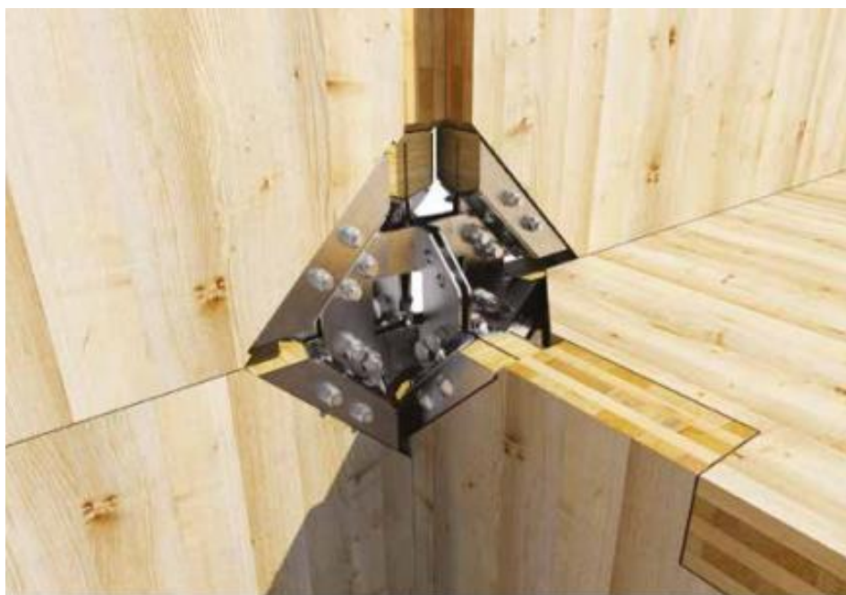
Figura 2.17 - Sistema de Ligação X-Rad
