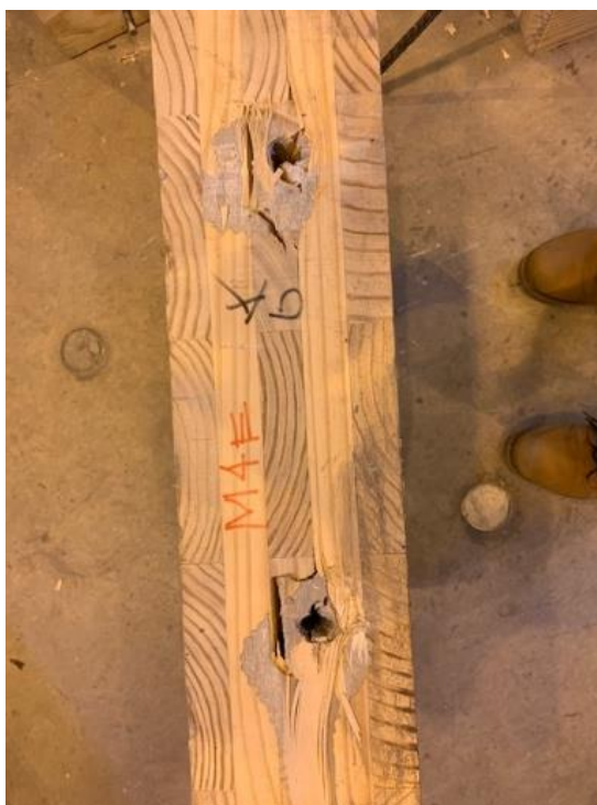
Figura 6.64 – Embutimento e arrancamento no modelo M4 de madeira/madeira
