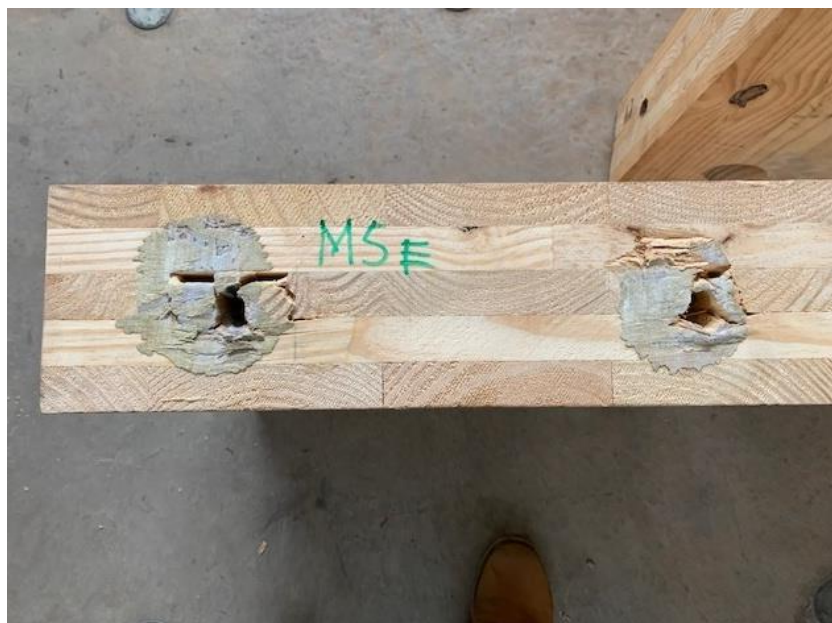
Figura 6.66 – Embutimento e arrancamento no modelo M5 de madeira/madeira
