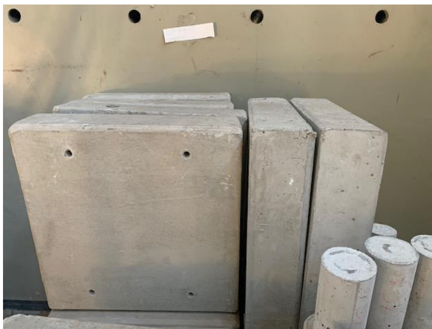
Figura 5.3- Laje de concreto pré-fabricada e corpos de prova cilíndricos
