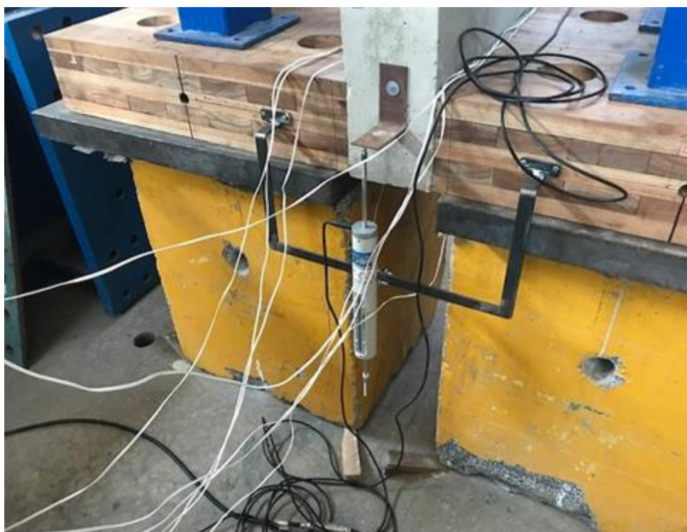
Figura 6.12 - Posicionamento dos transdutores de deslocamento
