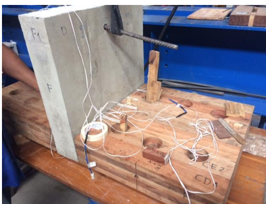
Figura 4.31 - Montagem dos extensômetros
