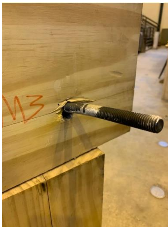
Figura 6.61 – Esmagamento da madeira e rótulas plásticas no modelo M3 de madeira/madeira
