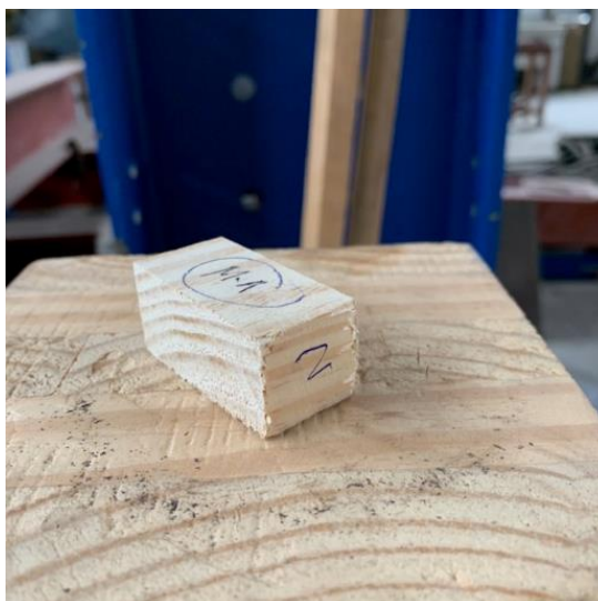
Figura 5.25 - Corpo de prova para verificação da densidade aparente
