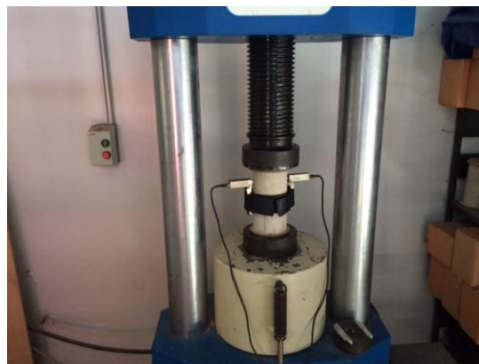
Figura 5.22 - Corpos de prova identificados Figura 5.23 - Prensa Hidráulica EMIC – PC 200
