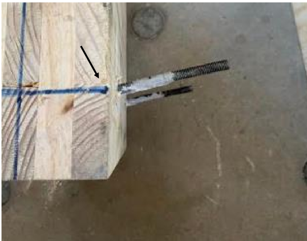
Figura 6.50- Embutimento do conector na peça principal
