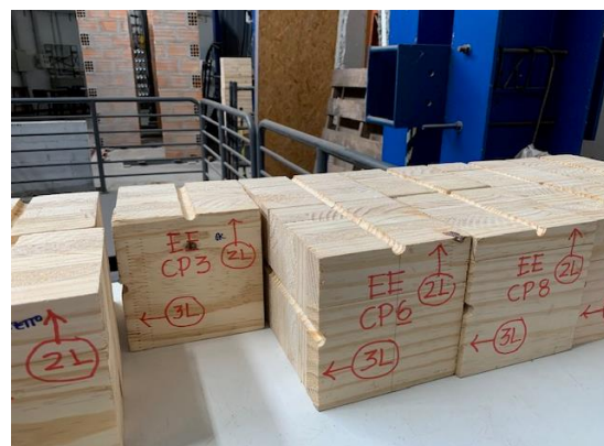
Figura 5.26 – CP para embutimento na madeira Figura 5.27 – CP para o ensaio de embutimento
