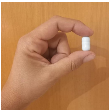
FIGURA 14 - Representação da pílula de telemetria Fonte: Arquivo pessoal, registro fotográfico realizado pela pesquisadora.
