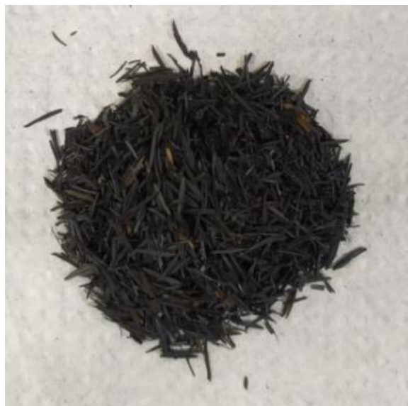
Figura 11 - Carvão de Casca de Arroz após pirólise convencional
