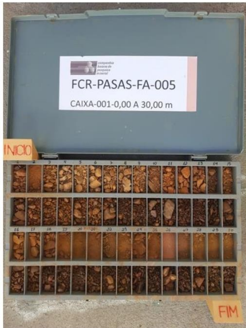
Fotografia 2 - Caixa de testemunho de sondagem de circulação reversa.
