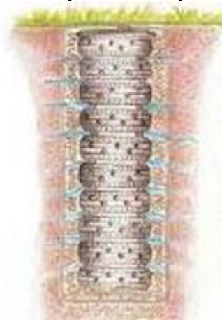
Figura 21 – Poço de infiltração com pneus
