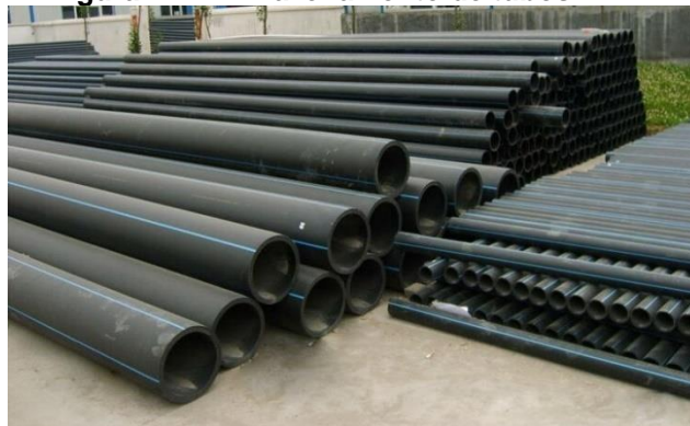
Figura 24 – Armazenamento de tubos PEAD
