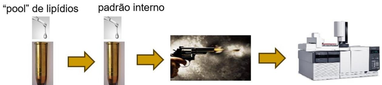
Figura19: Experimento 2 (EXP2), dopagem do estojo com “pool” de lipídios, dopagem com o padrão interno esqualano, disparo do estojo com arma de fogo, extração e injeção no GC/MS/MS.
