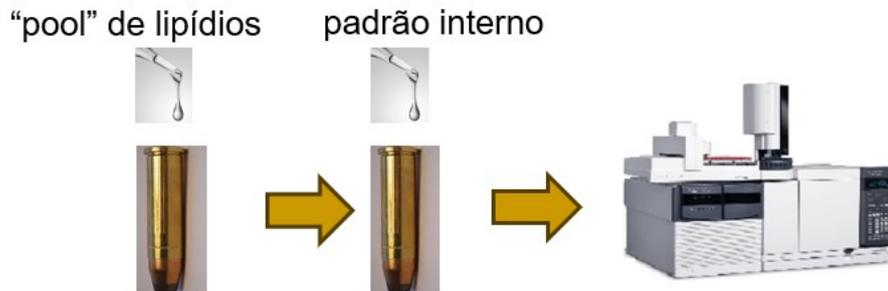
Figura18: Experimento 1 (EXP1), dopagem do estojo com “pool” de lipídios, dopagem com o padrão interno esqualano, extração e injeção no GC/MS/MS.
