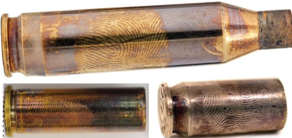
Figura 9: Revelação de fragmentos de FID em estojos percutidos e deflagrados utilizando da técnica de deposição de metal a vácuo. (figura adaptada de <https://www.west-technology.co.uk/forensic/wp-content/uploads/VMD-Brochure-May-2019-3.pdf>)
