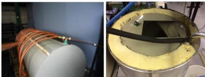
Figura 4-2- Fotos da montagem do resfriador de gás
