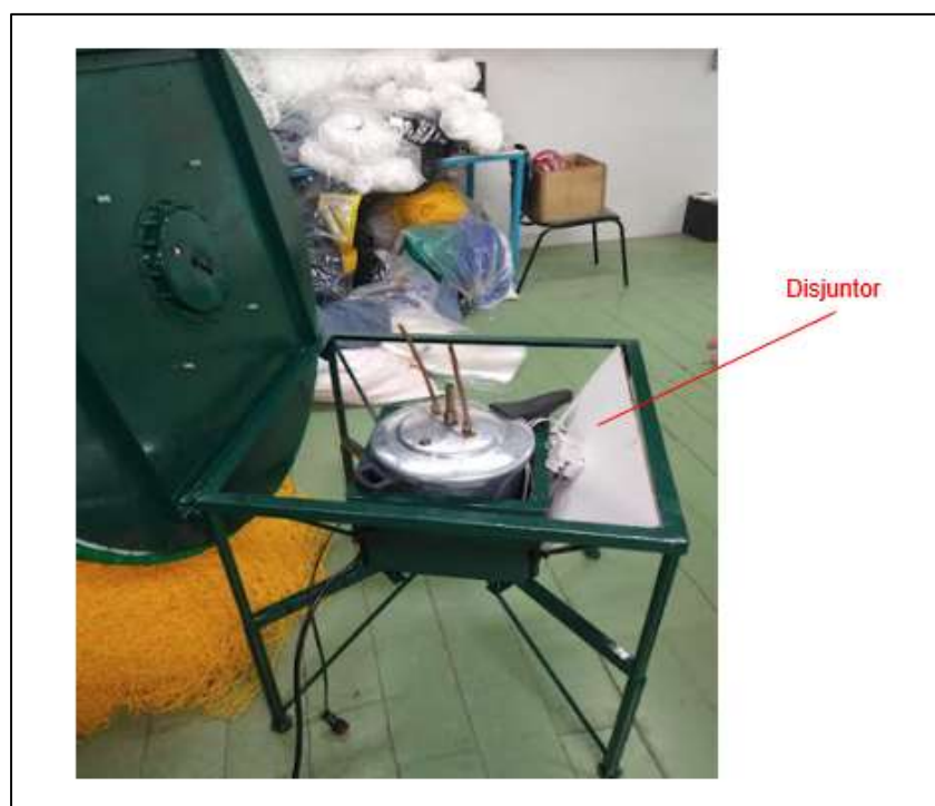
Figura 18 – Fonte de vapor. Destaque alimentação elétrica.
