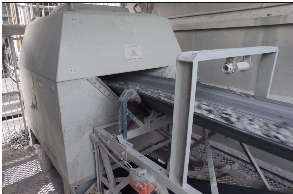
Figura 22. Analisador de calcário (PGNAA), da fabricante Thermo Fisher, em Candiota (foto).
