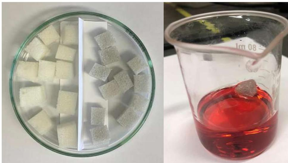
Figura 49 – Amostras de PU controle e PU-CCA-2-X em cubos e submissão destas em contato com óleo diesel por meio do ensaio rápido da ASTM F-726/12.
