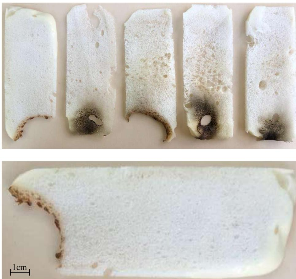
Figura 62 – Resultado de queima das amostras de PU Controle.
