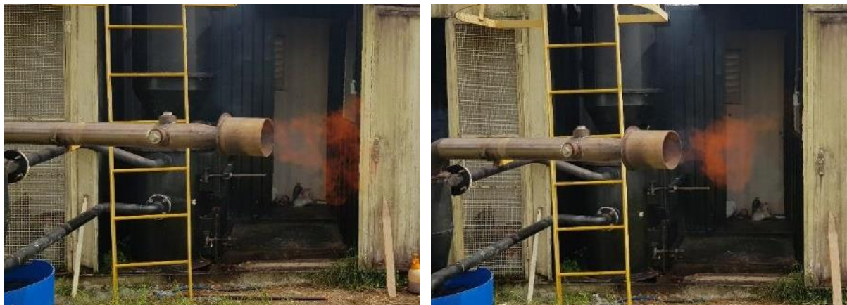
Figura 23 - Chamas resultantes da queima do gás de síntese de CDRU (esquerda) e madeira (direita)
