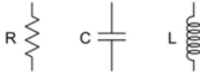
**Figura 2** – Representação dos elementos básicos de um circuito elétrico. Na sequência da direita pra esquerda: um resistor (R), um capacitor (C) e um indutor (L).
