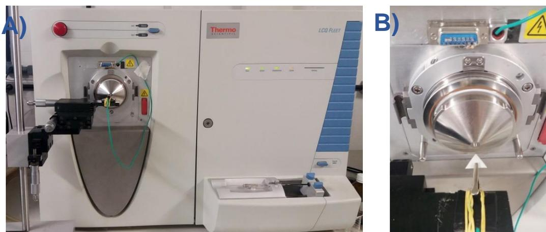
Figura 17. Aparato instrumental utilizado para as análises: a) Espectrômetro de massas Thermo LQC-Fleet; b) Fonte de ionização *paper spray*.
