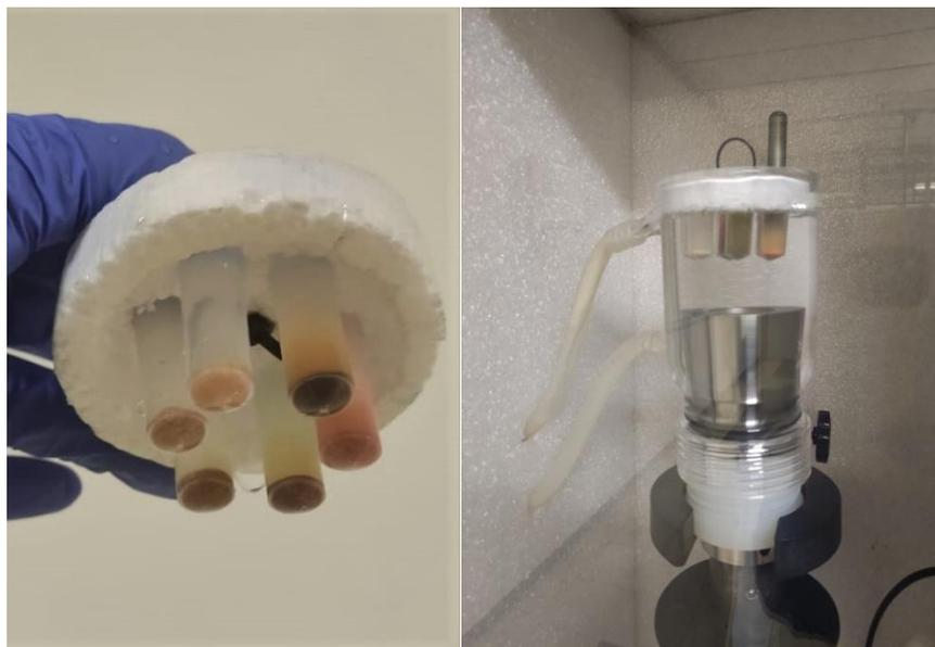
Figura 45. Imagem das amostras em etanol no processador ultrassônico com o acessório *cup horn*.
