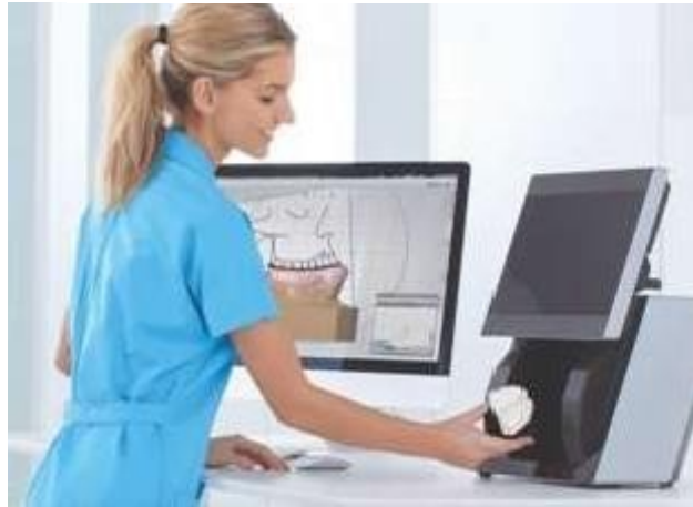
Figura 2 - exemplifica a digitalização de um modelo em gesso utilizando um escâner de bancada.
