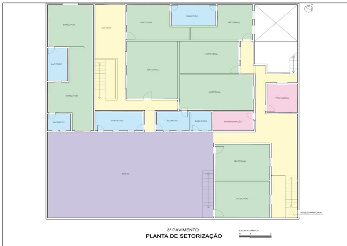
Figura 13 – Planta de setorização do terceiro pavimento
