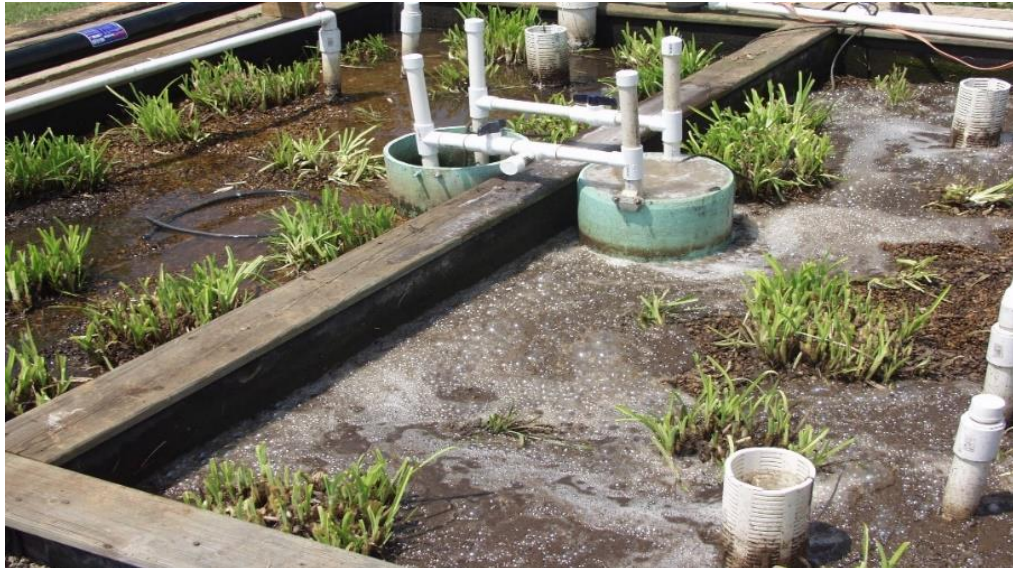
Figura 3-8: Aplicação de peróxido de hidrogênio em wetlands verticais. Nota-se um borbulhamento na superfície do leito em virtude da reação de oxidação. Fonte: Behrends (2006b).
