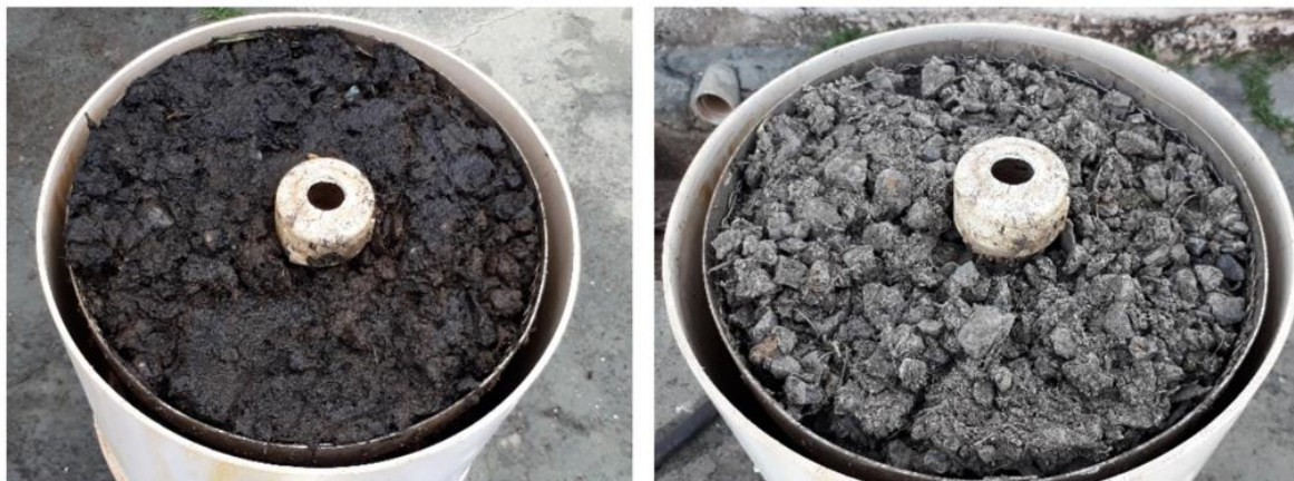
Figura 6-19: Amostra indeformada antes e após o período de repouso de 30 dias.
