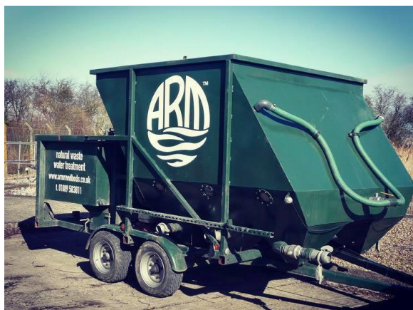
Figura 3-6: Equipamento para lavagem de meio suporte em wetlands. Fonte: ARM Group (2018).
