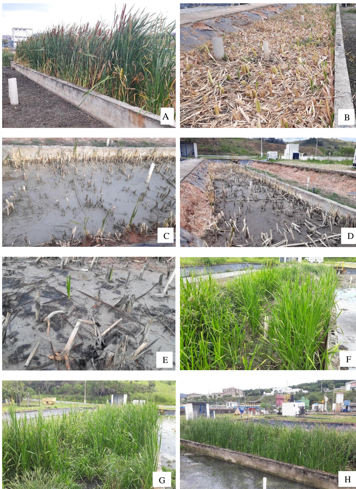
Figura 6-36: Unidade plantada antes e após aplicação do peróxido de hidrogênio. Fotos tiradas em: A) 29/10/2019 (14 dias antes), B) 10/11/2019 (2 dias antes), C) 12/11/2019 (no dia, após aplicação), D) 13/11/2019 (1 dia após), E) 18/11/2019 (6 dias após), F) 12/12/2019 (1 mês após), G) 13/01/2020 (2 meses após), H) 06/02/2020 (3 meses após).
