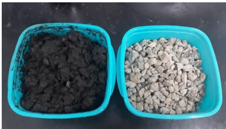
Figura 6-33: Amostra do material suporte antes (esquerda) e depois (direita) da aplicação de 1.847 mL de peróxido de hidrogênio.
