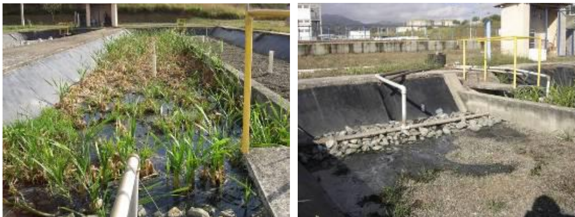
Figura 4-6: Surgimento do escoamento superficial no início das unidades plantada (esquerda) e não plantada (direita). Fonte: De Paoli (2010).
