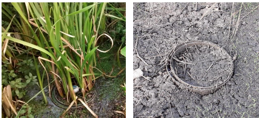
Figura 5-11: Cesta do reator do leito fixo inseridas nas unidades plantada (esquerda) e não plantada (direita) para ambientação/colmatação. Obs.: Foto tirada com o leito drenado na unidade não plantada.
