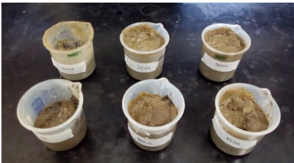
Figura 6-26: Amostras do leito reagindo com o peróxido de hidrogênio a 35%.
