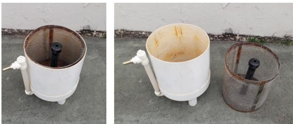
Figura 5-10: Reator de leito fixo, com e sem a cesta interna.
