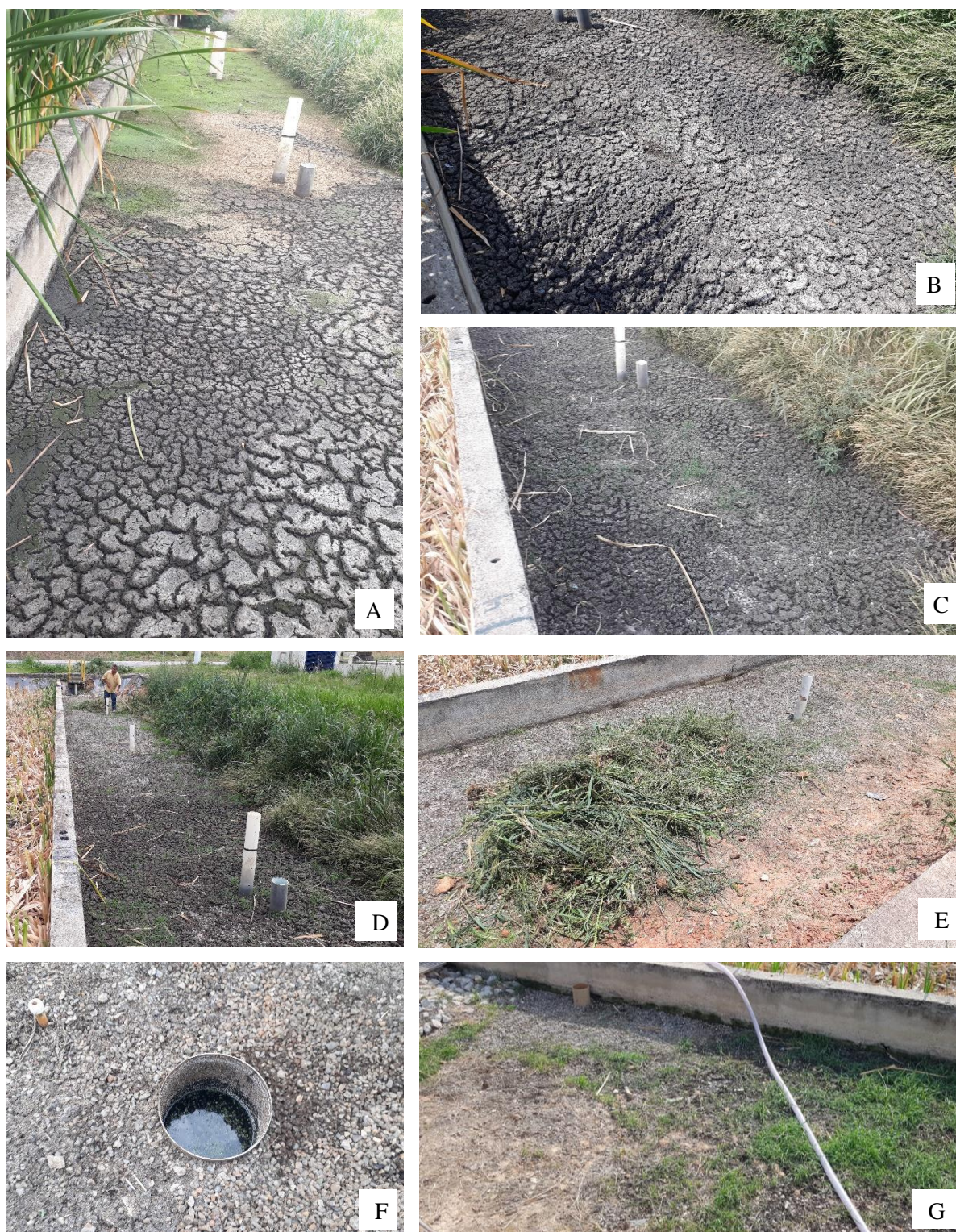
Figura 6-21: Unidade não plantada durante o período de repouso de 30 dias. Fotos tiradas em: A) 21/10/2019, 7 dias após interrupção da alimentação; B e F) 29/10/2019, 15 dias em repouso; C) 04/11/2019, 21 dias de repouso; D e E) 07/11/2019, 24 dias de repouso, sendo o dia da retirada do lodo e da vegetação invasora; G) 12/11/2019, 29 dias de repouso e após a retirada do lodo.
