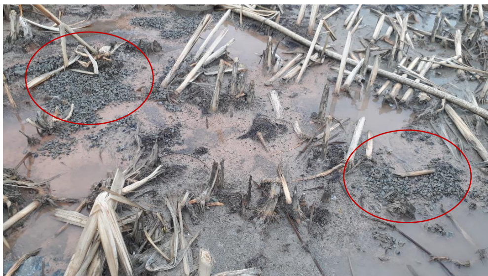
Figura 6-37: Trecho inicial do leito após a aplicação do peróxido de hidrogênio indicando o meio suporte limpo.
