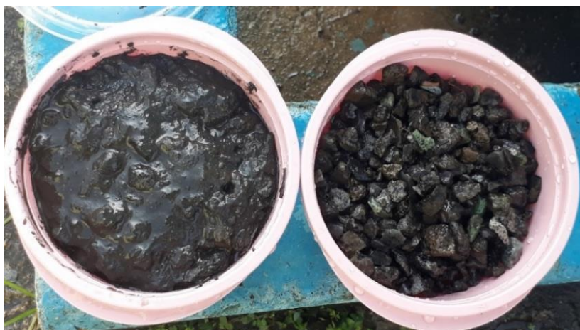
Figura 6-15: Amostra do material suporte antes (esquerda) e depois (direita) da lavagem 1.
