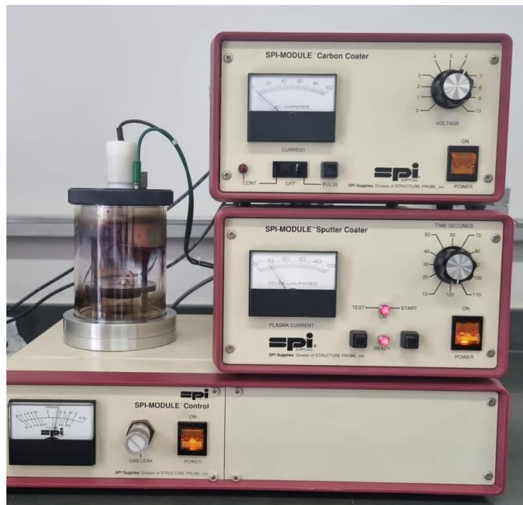
Figura 3- SPI Module (metalização das amostras antes de serem analisadas em MEV)
