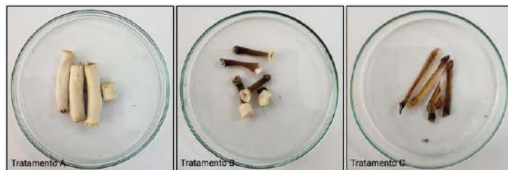
Figura 2 - Criogéis sintetizados a -12^{\circ}\text{C} , -9^{\circ}\text{C} e -1,5^{\circ}\text{C} (tratamento 9), após o processo de lavagem e secagem.
