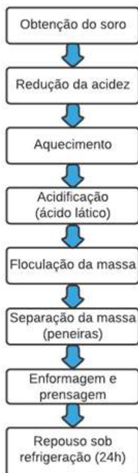
Figura 1 - Fluxograma do desenvolvimento da ricota
