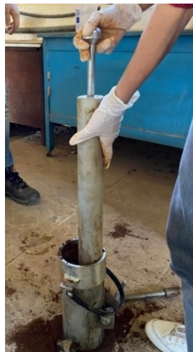
Figura 15 - Execução de golpes para compactação das camadas da amostra
