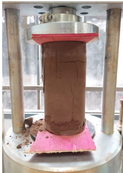
Figura 19 - Ensaio de resistência a compressão simples não confinada
