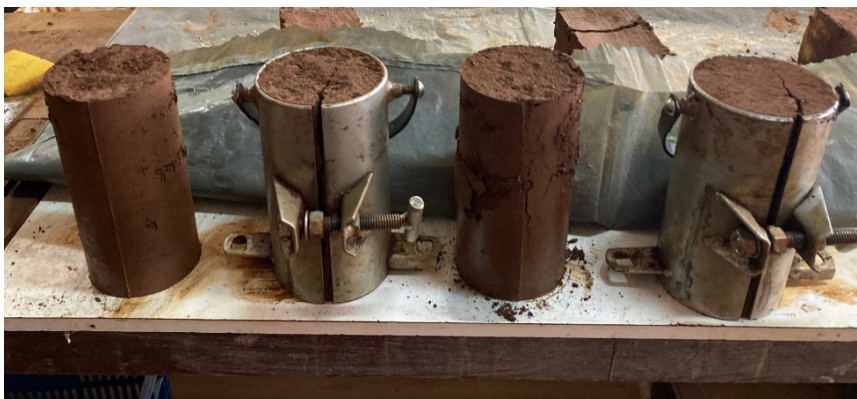
Figura 27 - Fissuras nas amostras com 60% de SRMF-RD
