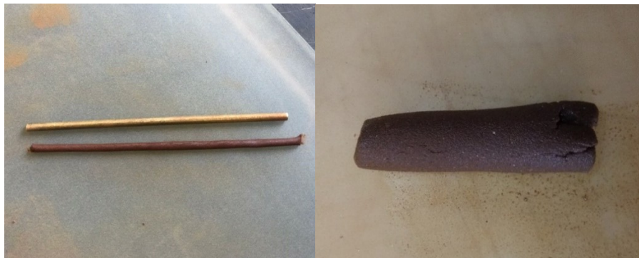
Figura 22 - Realização do ensaio de plasticidade
