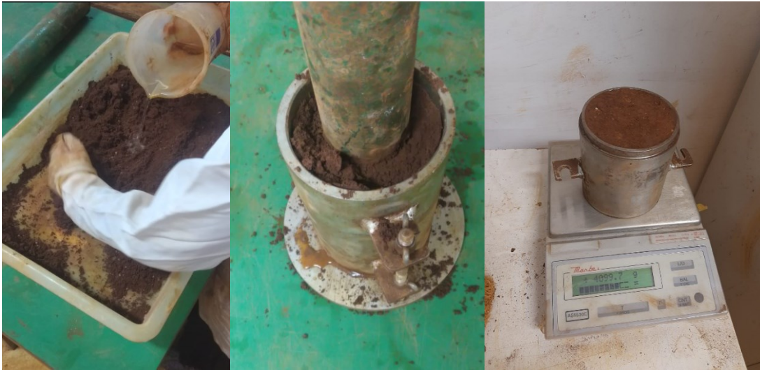
Figura 12 - Execução do ensaio de compactação
