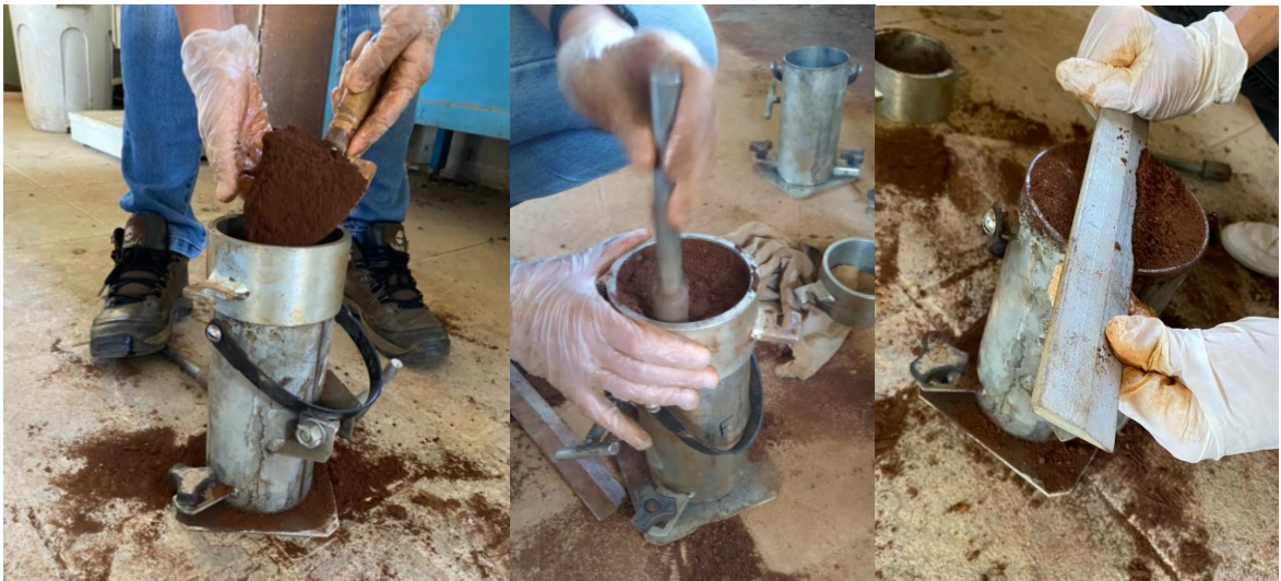
Figura 14 - Processo de moldagem de corpos de prova cilíndricos representativos da taipa de pilão
