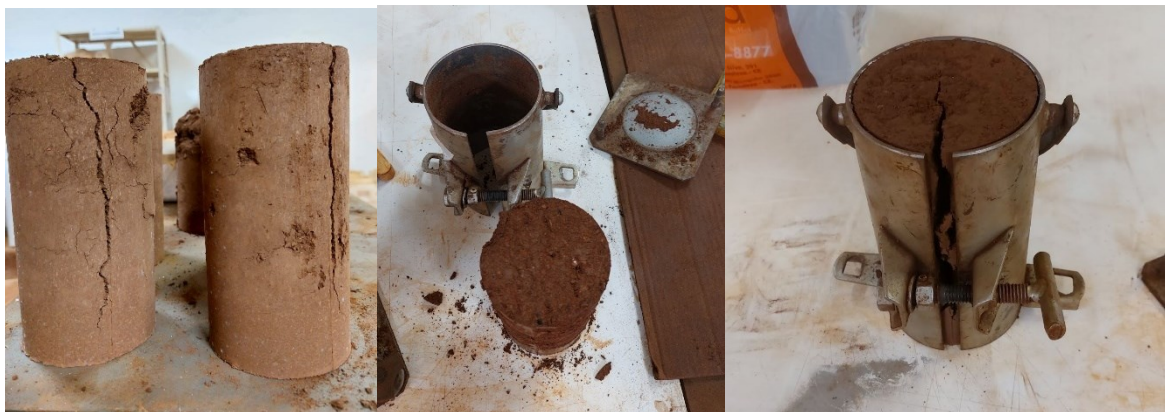
Figura 16 - Corpos de prova com trincas, desagregação e aderência de material na fôrma
