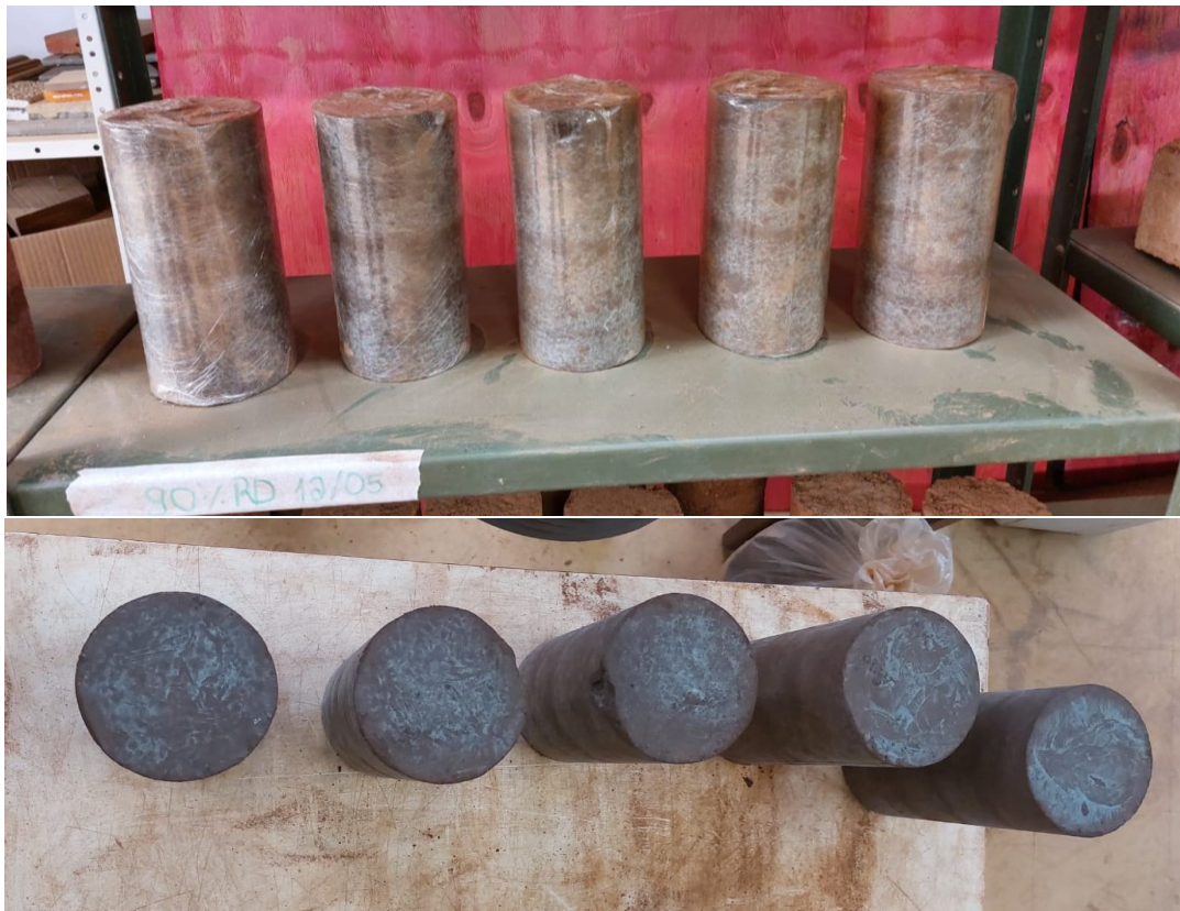
Figura 20 - Traço SRMF-90-RD embalado no plástico (acima) e após a retirada do plástico (abaixo)
