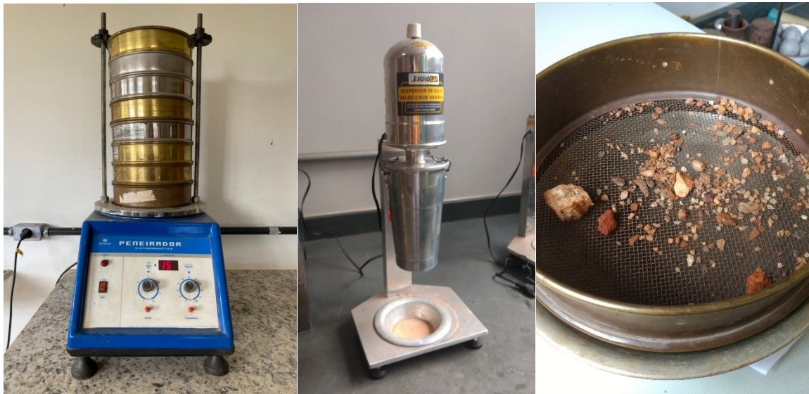
Figura 10 - Ensaio de granulometria por sedimentação e peneiramento
