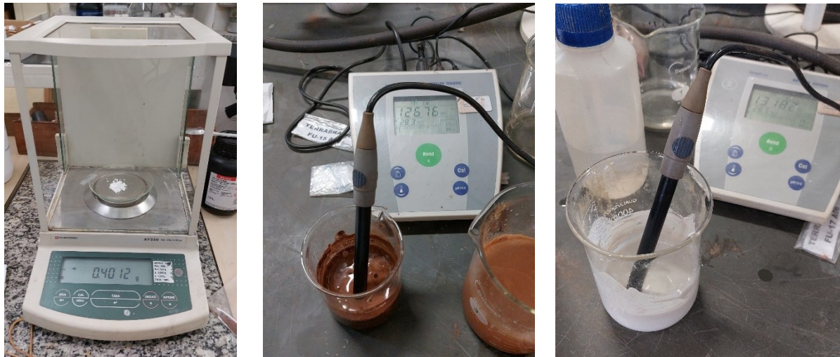
Figura 13 - Medição do pH das misturas solo-SRMF
