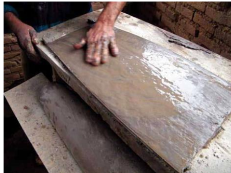
Figura 45 - Feitura da telha utilizando as ferramentas da Figura 44
