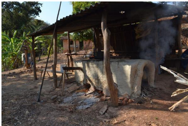
Figura 63 - Fornalha de fabricação de rapadura de adobe e barro branco
