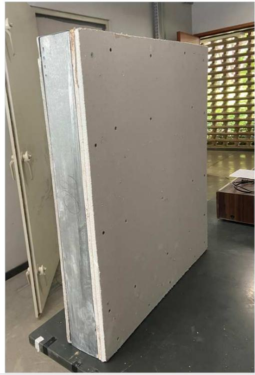
b) Vista interna do painel móvel para ensaio térmico
