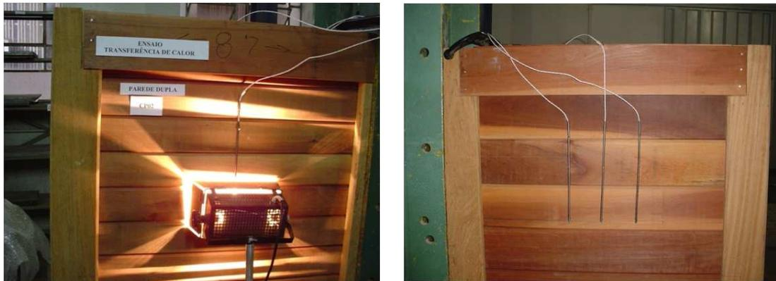
a) Vista externa da parede dupla para ensaio térmico com a fonte térmica utilizada.
