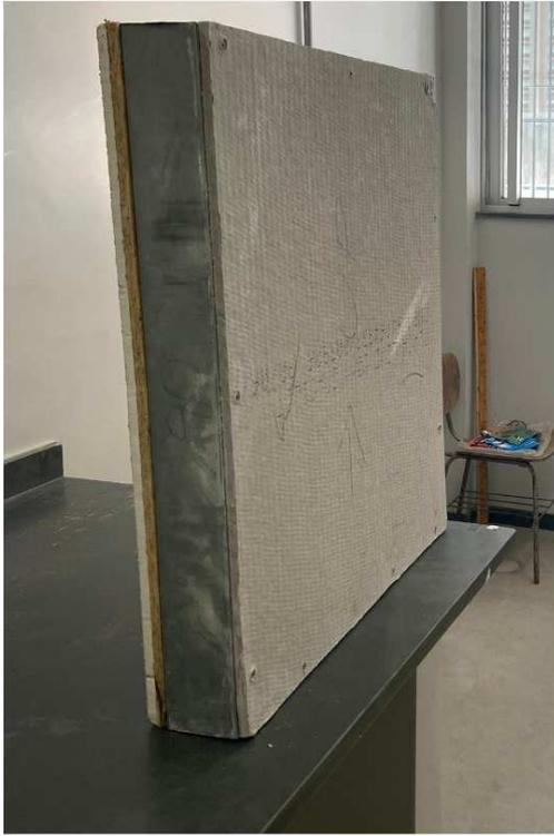
a) Vista externa do painel móvel para ensaio térmico
