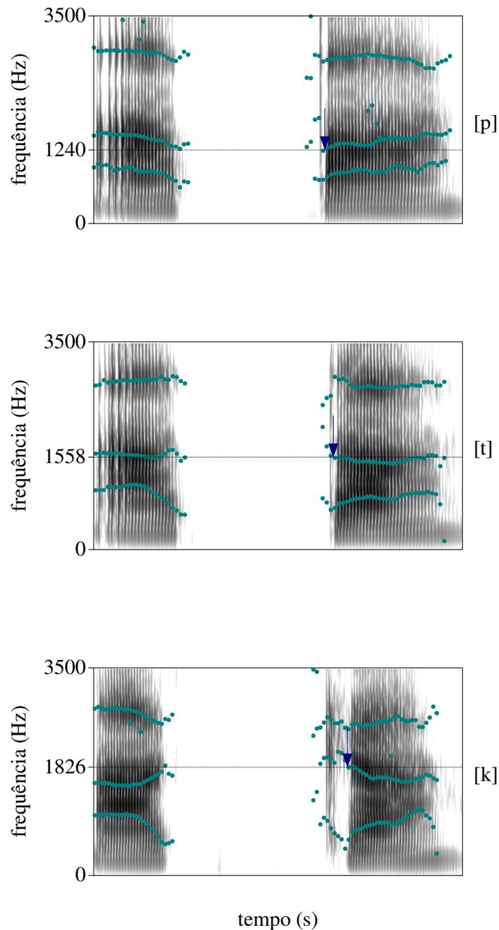
**Figura 14.** Espectrogramas de oclusivas intervocálicas e medição do F2 na transição.
