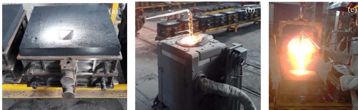
FIGURA 3.4 - a) moldação; b) fusão; c) vazamento dos corpos de prova. FONTE - A autora (2023).
