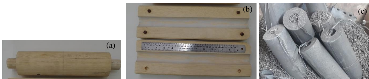
FIGURA 3.2 - a) modelo, b) caixa de macho, c) corpo de prova após fundição. FONTE - A autora (2023).
