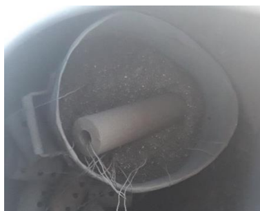
FIGURA 3.5 - Corpos de prova encobertos com grafite. FONTE - A autora (2023).
