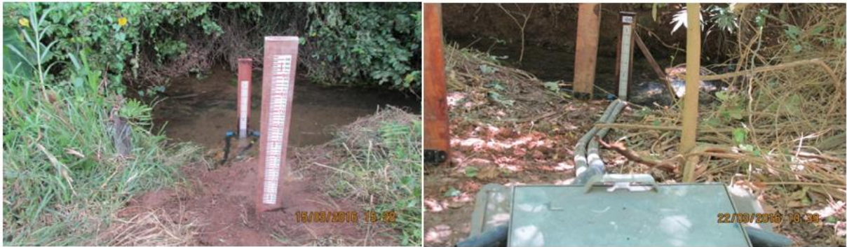
Figura 2.4 – Exemplo de estação fluviométrica instalada nos córregos Samambaia (foto a esquerda) e Jaguará (foto a direita), com indicação das réguas instaladas e dos equipamentos instalados para armazenar o transdutor de pressão.
