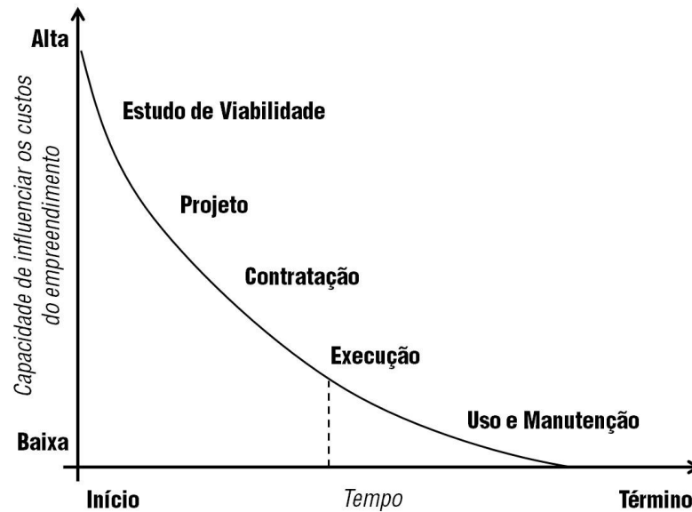
Figura 1 – Capacidade de influenciar o custo final de um empreendimento ao longo de suas fases
