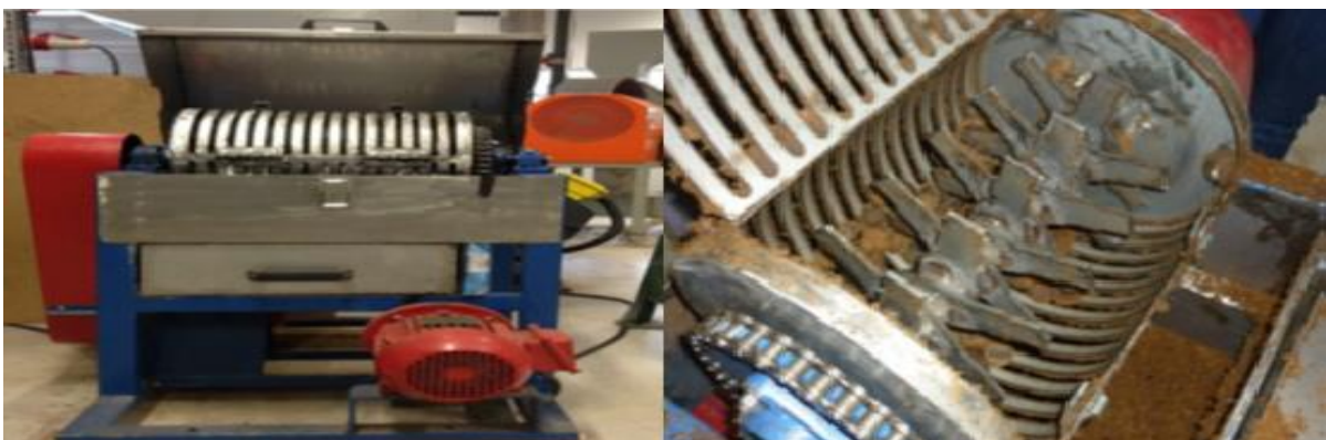
Figura 8. Despolpador mecânico marca RM Ltda. para frutos da macaúba. Vista geral (esquerda) e câmara de despolpamento (direita).
