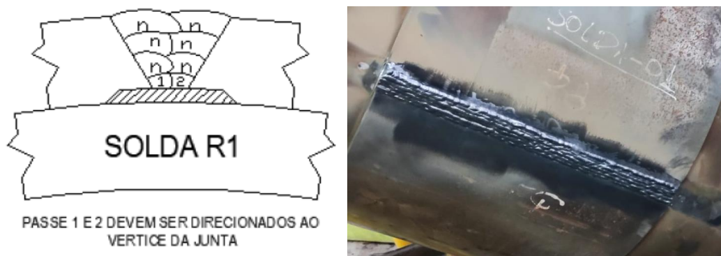
Figura 23 - Aspecto final da solda longitudinal (solda de chanfro).
