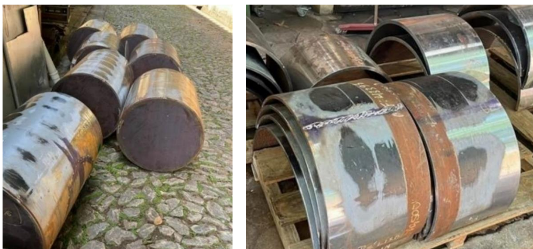
Figura 16 - Conjuntos para fabricação das peças de teste (ao lado esquerdo o tubo condutor, ao lado direito, luvas bipartidas).
