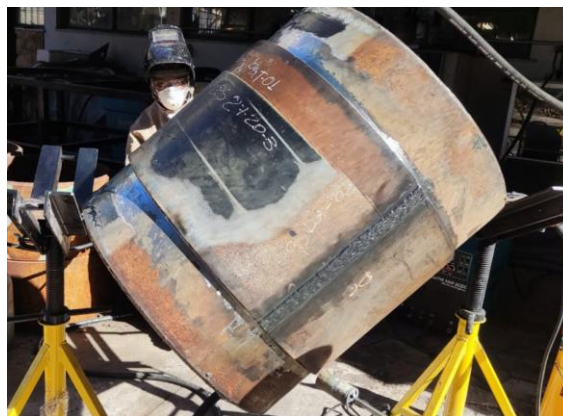
Figura 14 - Configuração de montagem em campo para qualificação de soldagem em serviço da peça de teste.
