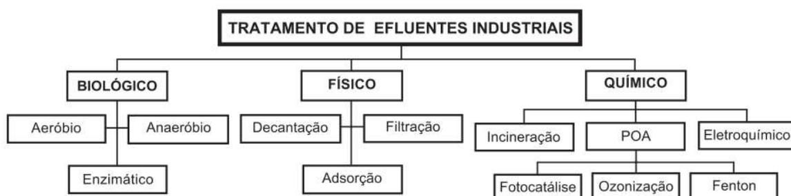
Figura 3-2: Principais classes e processos aplicados em tratamento de água<sup>32</sup>.
