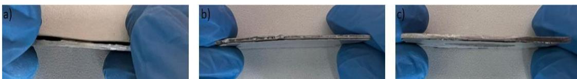
**Figura 37** - Amostras de aço galvanizado com revestimento orgânico à base de resina epóxi após 90 dias de imersão em NaCl 3,5% a) sem pré-tratamento b) com silano e inibidor c) monocamada de silano.
