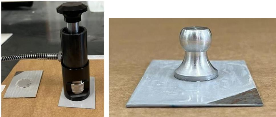
**Figura 28** - Teste de Aderência pull-off
